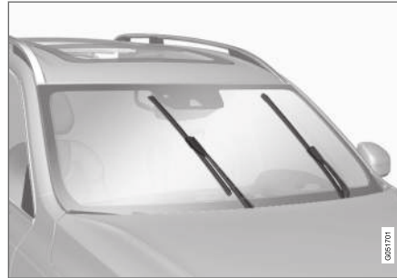
Очисники лобового скла у положенні для обслуговування.
