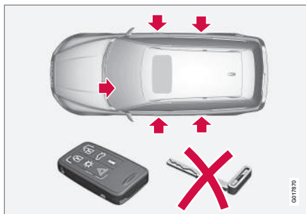
Активні замки для ключа ДК без знімного ключа та функції приватного замикання активовані .
