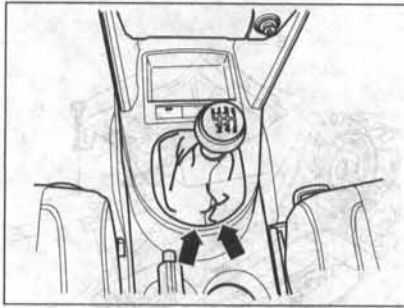
5.1 Высвободите с помощью пластмассового клина гофрированный чехол рычага из крепления на центральной консоли (см. стрелки)
