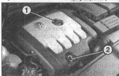
8.37 Снимите крышку 1 с маслозаправочной горловины и залейте свежее масло. 2 - стержневой указатель (щуп) уровня масла
