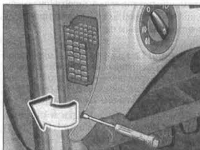
5.3 Подденьте боковую крышку на панели приборов отверткой или пластмассовым клином, например, HAZET 1965-20 и снимите её (см. стрелку). Автомобили Golf
