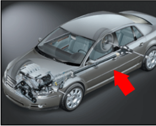
V278 Door Closing Assist Motor
