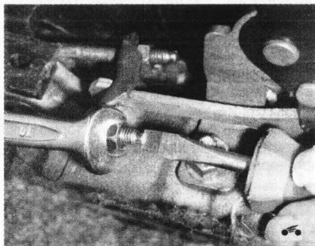
8. Удерживая отверткой резьбовой наконечник троса, отверните регулировочную гайку.
