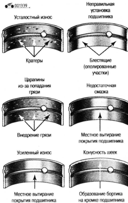
Рис. 4.38. Виды повреждений вкладышей
