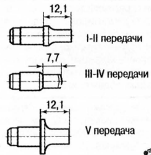
Рис. 5.34. Размеры наконечников вилок включения передач
