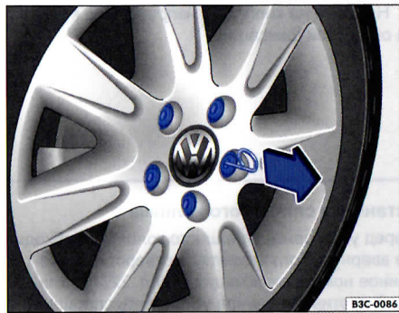
Илл. 225 Снятие колпачков колёсных болтов.
