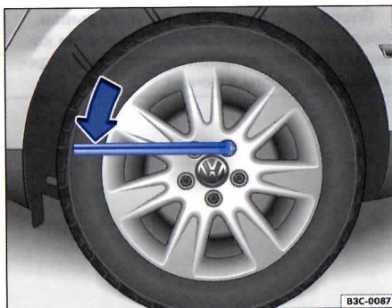
Илл. 226 Замена колеса: ослабление колёсных болтов.
