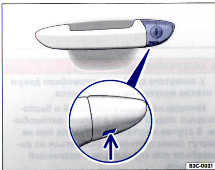
Илл. 211 Ручка двери водителя: скрытая личинка замка.
