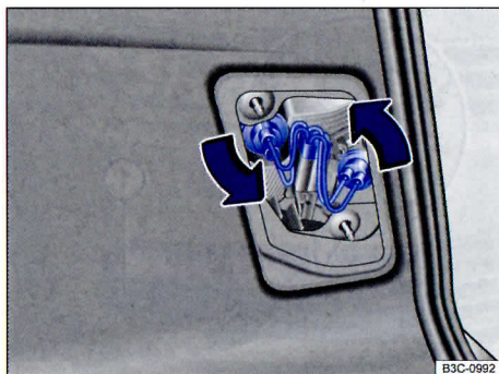
Илл. 243 Крышка багажного отсека: снятие ламп накаливания.
