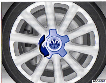
Илл. 223 Откручивание колпака ступицы.
