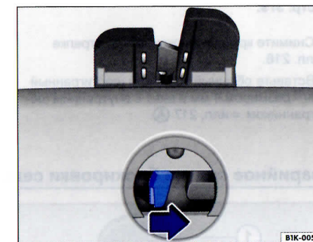
Илл. 215 В багажном отсеке: аварийное отпирание.
