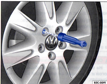
Илл. 232 Замена колеса: выворачивание колёсных болтов ручкой отвёртки.
