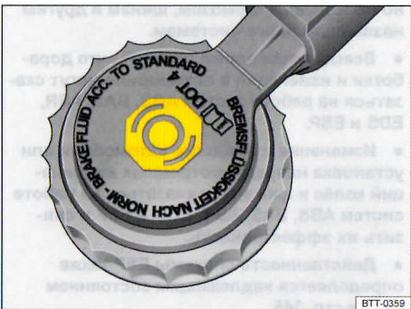
Илл. 148 В моторном отсеке: крышка бачка тормозной жидкости (вариант 1).
