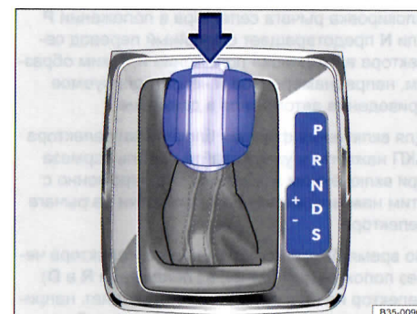
Илл. 143 Селектор АКП с блокировочной кнопкой (стрелка) автомобиля с правым рулём.
