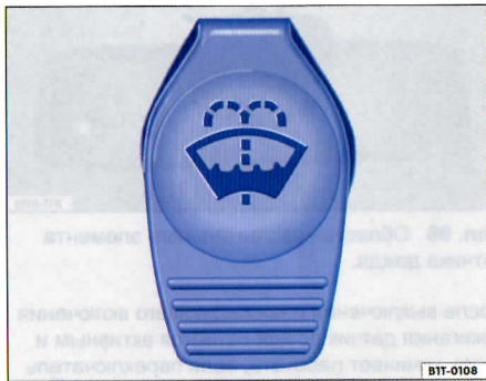
Илл. 99 Крышка бачка стеклоомывателя в моторном отсеке.
