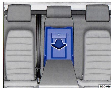
Илл. 105 Открытие люка для перевозки длинномерных грузов в спинке заднего сиденья.
