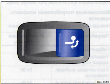
Илл. 114 В багажном отсеке справа: клавиша разблокирования шарового наконечника.
