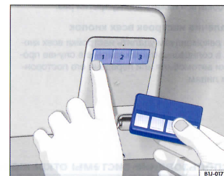
Илл. 38 Для программирования: одновременно нажмите кнопку на пульте системы открывания ворот и на пульте ДУ.
