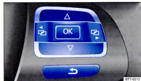
Илл. 14 Правая сторона многофункционального рулевого колеса: клавиши управления меню в комбинации приборов.
