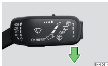
Илл. 337 Установка поводков стеклоочистителя в сервисное положение
