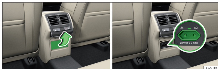
Илл. 122 Открытие крышки розетки на 230 В/розетка на 230 В
