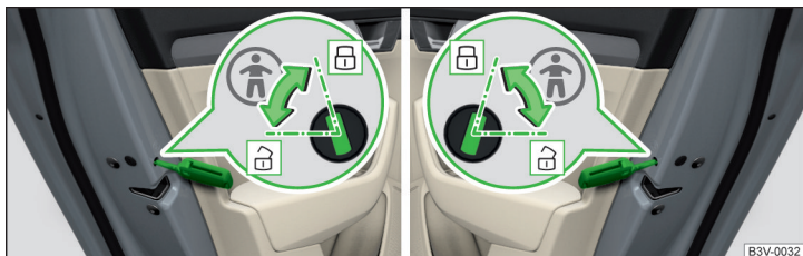
Илл. 45 Задняя дверь: включение и выключение «детской» блокировки
