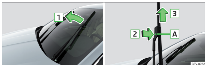
Илл. 338 Замена щётки стеклоочистителя ветрового стекла
