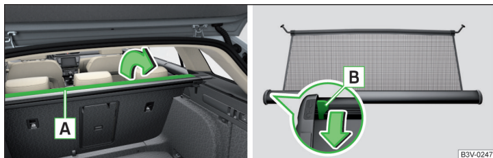
Илл. 153 Раскладывание части сматываемой шторки багажного отсека/рычага разблокировки
