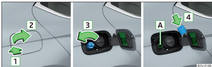
Илл. 301 Открыть крышку лючка заливной горловины/отвернуть пробку заливной горловины/надеть пробку на крышку лючка
