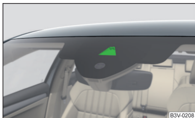
Илл. 61 Окно датчика ассистента управления освещением на ветровом стекле
