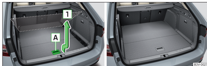
Илл. 149 Перевод трансформируемого пола в верхнее положение/трансформируемый пол в верхнем положении
