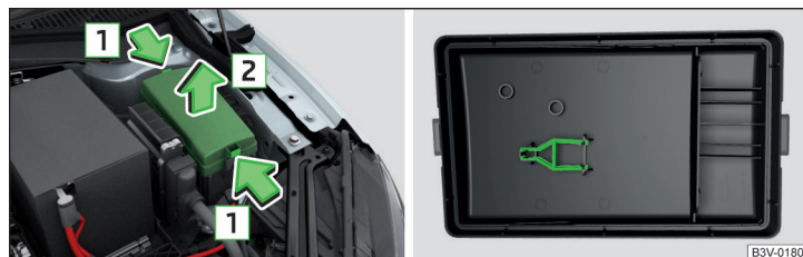
Илл. 345 Крышка блока предохранителей: снятие крышки/пластмассовый пинцет для предохранителей
