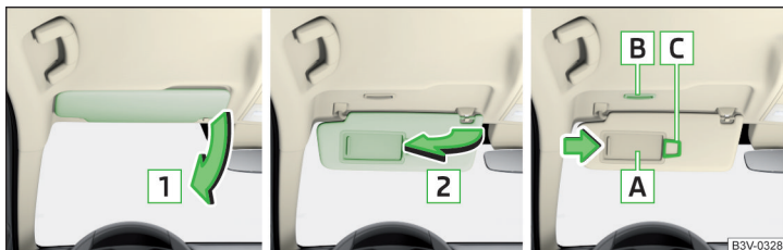
Илл. 68 Опускание козырька/поднимание козырька/косметическое зеркало с подсветкой и зажимом для парковочного талона
