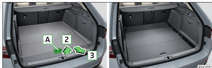
Илл. 150 Перевод трансформируемого пола в нижнее положение/трансформируемый пол в нижнем положении
