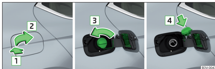
Илл. 299 Открыть крышку лючка заливной горловины/отвернуть пробку заливной горловины/надеть пробку на крышку лючка
