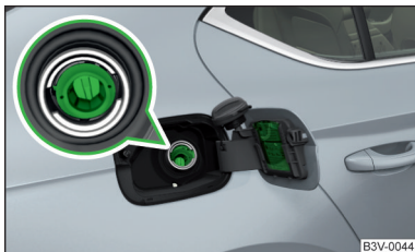
Илл. 300 Горловина топливного бака автомобилей с дизельным двигателем
