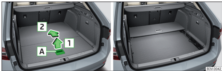
Илл. 151 Складывание трансформируемого пола/сложенный трансформируемый пол в верхнем положении
