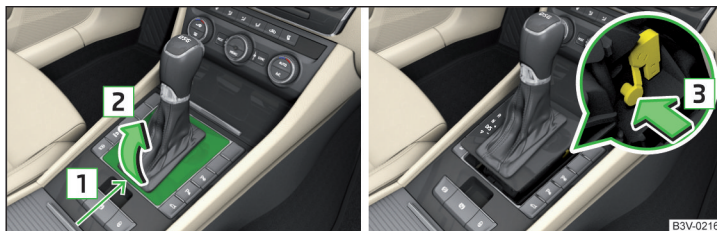
Илл. 336 Снятие крышки/разблокировка рычага селектора
