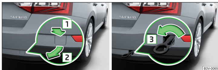
Илл. 326 Снятие крышки/установка буксирной проушины
