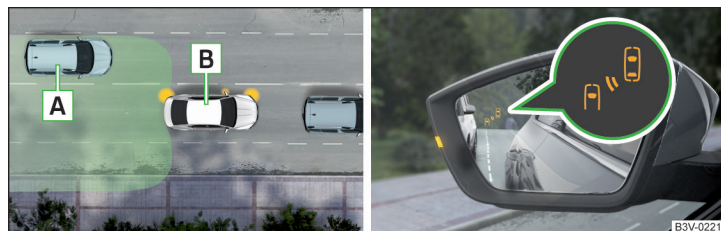
Илл. 262 Дорожная ситуация/индикатор в левом наружном зеркале сигнализирует о ситуации
