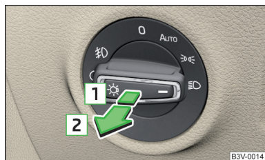
Илл. 59 Переключатель освещения: включение противотуманных фар/заднего противотуманно- го фонаря
