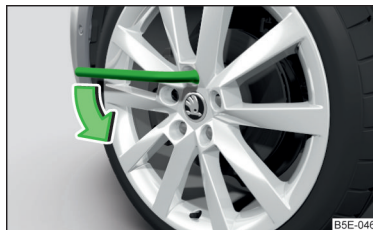
Илл. 319 Отворачивание колёсных болтов
