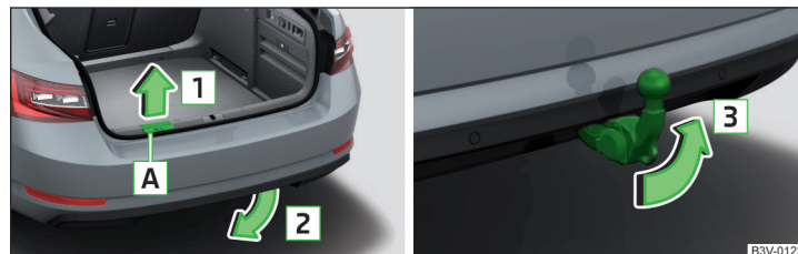
Илл. 295 Шаровой наконечник ТСУ: откидывание и убиение
