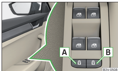
Илл. 46 «Детская» блокировка с электрическим приводом
