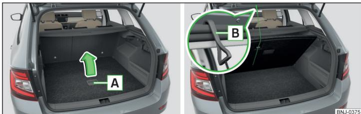
Илл. 119 Подъём/фиксация трансформируемого фальшпола багажного отсека
