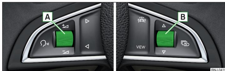
Илл. 38 Клавиши/регуляторы на многофункциональном рулевом колесе
