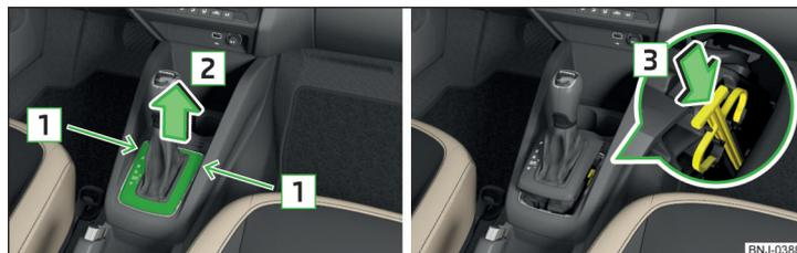
Илл. 276 Снятие крышки/разблокировка рычага селектора
