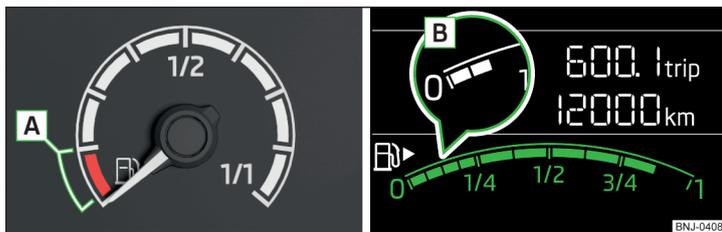
Илл. 32 Указатель уровня топлива: в комбинации приборов/на дисплее комбинации приборов
