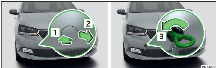
Илл. 269 Снятие крышки/установка буксирной проушины
