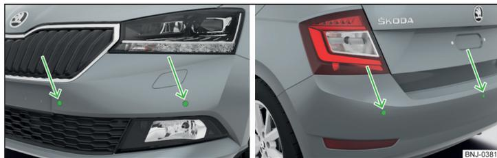
Илл. 205 Место установки датчиков на левой стороне автомобиля: спереди/сзади
