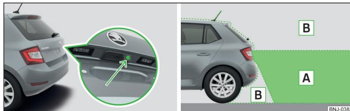
Илл. 214 Место установки камеры/зона видимости сзади автомобиля
