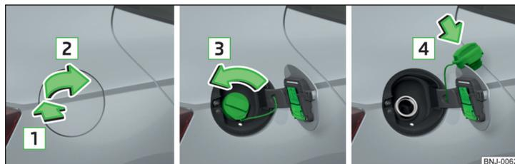
Илл. 245 Открыть лючок/отвернуть пробку заливной горловины/насадить пробку на крышку лючка
