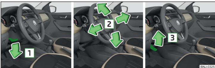
Илл. 15 Регулировка положения рулевого колеса
