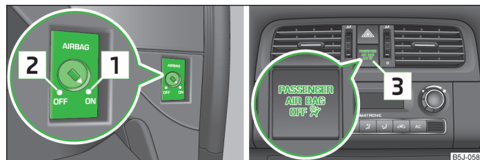
Илл. 117 Выключатель с замком для подушки безопасности переднего пассажира / контрольная лампа отключения/включения подушки безопасности переднего пассажира
