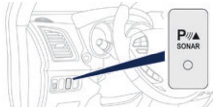
Система активируется с включением передачи заднего хода. При этом звучит сигнал зуммера.
