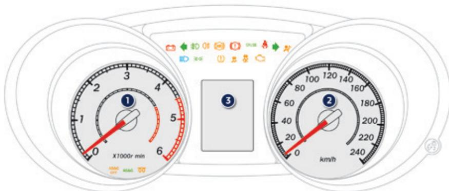
Это часть панели управления, на которой находятся контрольные приборы и сигнализаторы. Сигнализаторы информируют водителя о работе соответствующих систем (напр., контрольные лампы включения или отключения системы) или о появлении сбоя в их работе (уведомляющие сигнализаторы).
