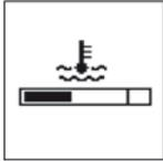
Этот прибор показывает температуру охлаждающей жидкости в системе охлаждения работающего двигателя.
