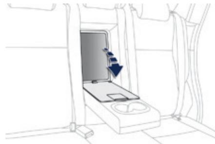
Устройство, позволяющее перевозить длинномерные предметы.
