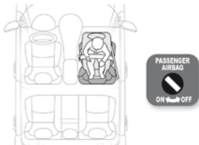
При установке детского кресла "спинкой вперед" на **сиденье переднего пассажира**, отодвиньте его в среднее положение продольной регулировки, поднимите подушку и выпрямите спинку. Подушку безопасности пассажира следует обязательно отключать. Иначе **надувшаяся подушка безопасности может тяжело травмировать или повлечь гибель ребенка**.
