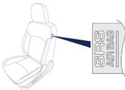
Боковые подушки безопасности предназначены для дополнительной защиты водителя и переднего пассажира от травмирования грудной клетки при сильном боковом ударе в ДТП. Обе подушки встроены в спинки передних сидений со стороны двери.
