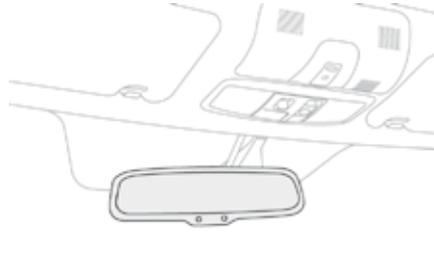
Датчик освещенности определяет яркость расположенного за автомобилем источника света, и внутрисалонное зеркало заднего вида плавно регулируется в режиме день/ночь.
