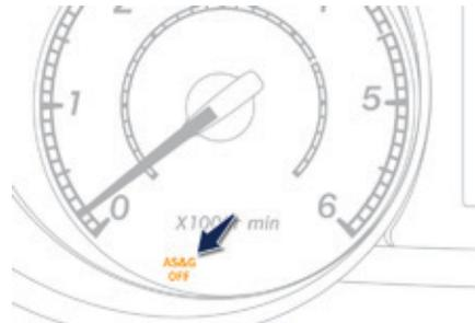
В случае выхода системы из строя, на панели приборов или ее дисплее будет мигать контрольная лампа **"AS&G OFF"**, означающая, что система не работает. Обратитесь в сервисную сеть PEUGEOT или в специализированный техцентр. В случае неисправности в режиме STOP двигатель автомобиля может заглохнуть. При этом на панели приборов или ее дисплее загорятся следующие контрольные лампы:
