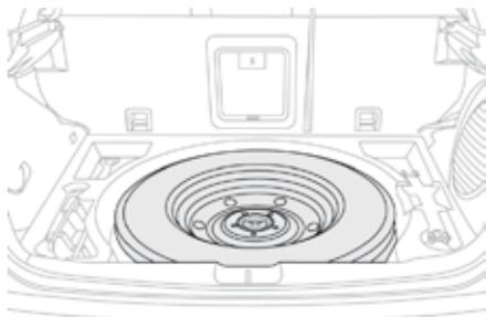
Запасное колесо находится под полом багажного отсека.
