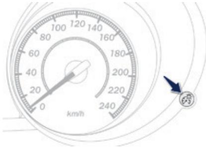
Независимо от того, включены или выключены световые приборы, нажмите на кнопку регулятора, чтобы изменить яркость подсветки панели приборов на "дневную" или "ночную".
