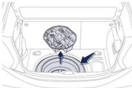
Запасное колесо находится в нише пола багажного отсека. В зависимости от страны поставки, запасное колесо может быть смонтировано либо на штампованном диске, либо на легкосплавном, либо на неполноразмерном типа "галета". О том, как его достать, читайте в разделе "Доступ к инструментам".
