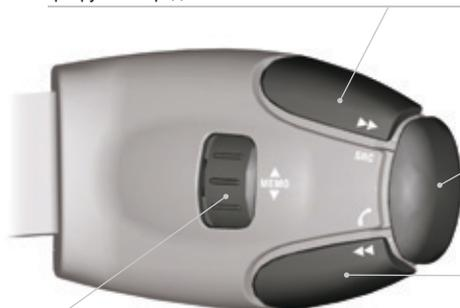
РАДИОПРИЕМНИК: выбор радиостанции из памяти в нижнем / верхнем частотном диапазоне.
