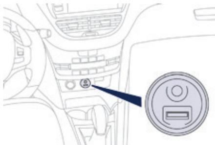
Данный блок подключения представляет собой разъемы JACK и USB, он расположен на центральной консоли.
