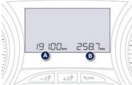
Счетчик общего пробега индицируется в зоне **A** дисплея, а счетчик суточного пробега - в зоне **B**.
