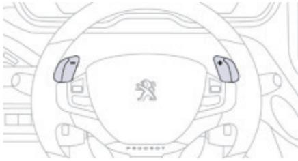
Правильный выбор передачи вручную позволяет, например, совершить обгон, сохраняя при этом работу коробки передач в автоматическом режиме.
