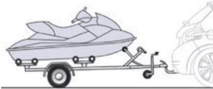
Установленное на автомобиле тягово-сцепное устройство служит для буксировки прицепа или установки на нем креплений для перевозки велосипедов; оно оборудовано световой сигнализацией.
