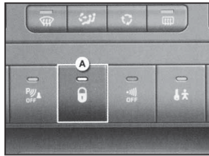
3.3 Выключатель (А) единого замка в панели приборов
