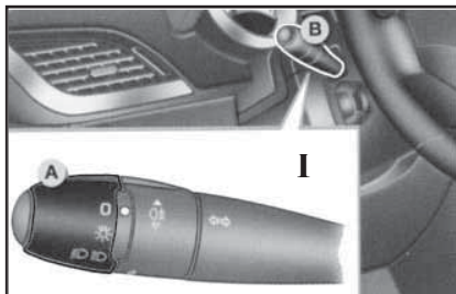
17.2 Кольцевой регулятор (А) выбора режимов функционирования ближнего и дальнего света фар, габаритных (парковочных) огней левого подрулевого переключателя (В)
