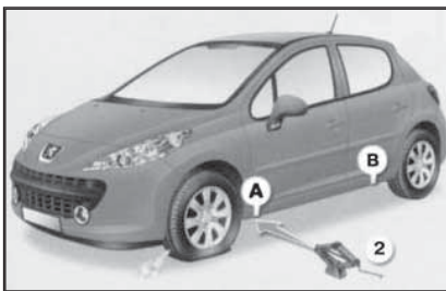
10 Расположение порожних домкратных точек (А, В)
