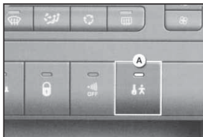
3.5 Блокировка замков задних дверей с выключателя (А), расположенного на консольной секции панели приборов (электропривод)
