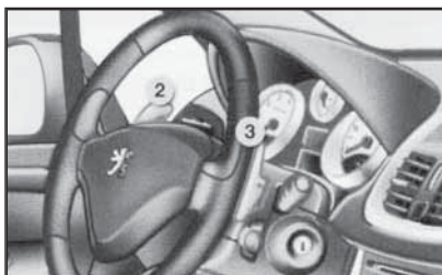
25.1 Переключение передач в положении "M" рычага 2Tronic может быть произведено с подрулевых переключателей
