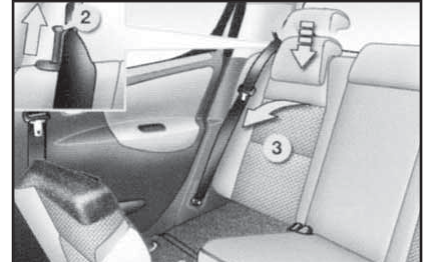
12.11 Для откидывания спинки (3) заднего сиденья отожмите рычаг (2)
