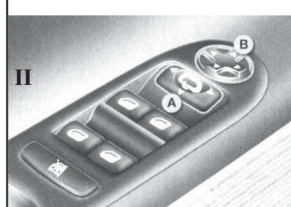
17.12 Панель переключателей управления приводом дверных зеркал заднего вида на подлокотнике водительской двери
