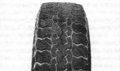
ЧЕШУЙЧАТЫЙ ИЗНОС ПРОТЕКТОРА, ВЫЗВАННЫЙ НАРУШЕНИЕМ УГЛОВ УСТАНОВКИ КОЛЕС
