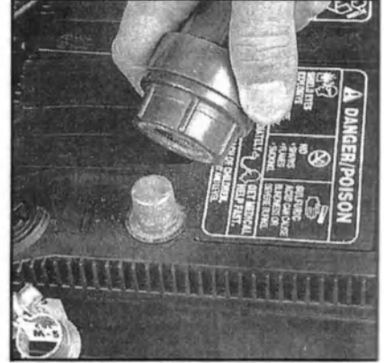
11.10b Зачистка полюсной клеммы
