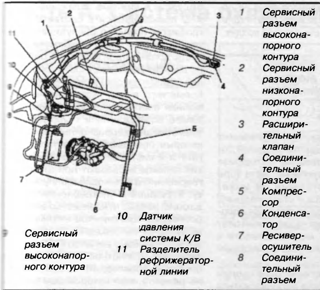
1.12 Общая компоновка элементов системы К/В в двигательном отсеке
