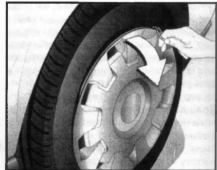
6 Демонтаж декоративного колпачка
