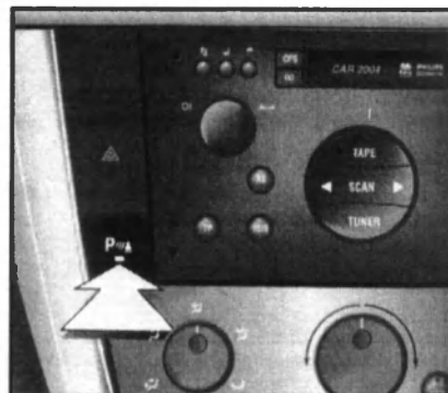
17.11 Выключатель системы помощи при парковке
