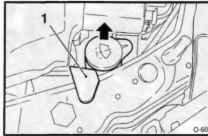
8.6 Крепежная скоба (1) патрубка заливной горловины резервуара для омывающей жидкости – стрелкой указано направление снятия патрубка
