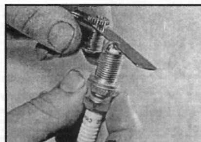
22.10б Проверка межэлектродного зазора при помощи щупа лезвийного типа
