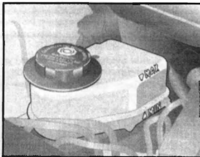
4.23 Уровень рабочей жидкости в резервуаре ГТЦ хорошо просматривается сквозь его полупрозрачные стенки
