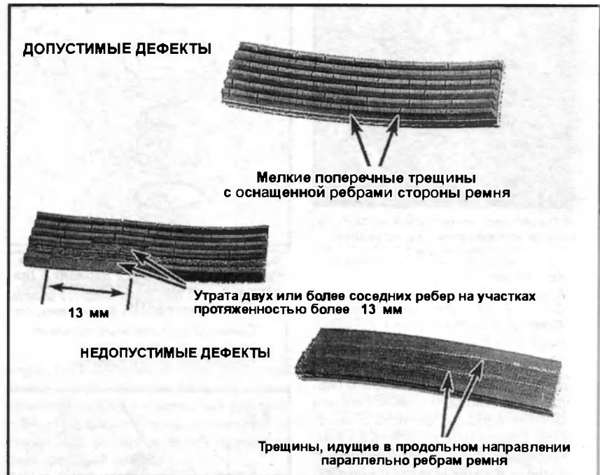
7.2 Типичные примеры износа многоручьевых приводных ремней
