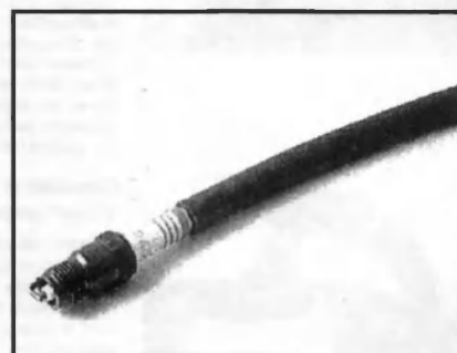
22.13 Во избежание повреждения резьбы в головке цилиндров в результате перекоса свечей, их следует наживлять при помощи отрезка топливного шланга, надеваемого на хвостовик
