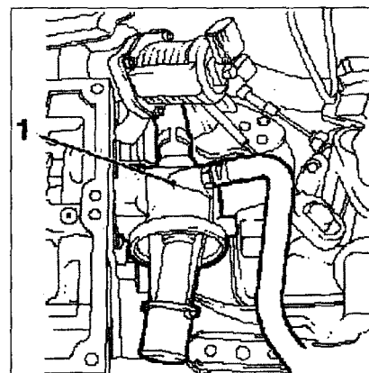
4.63 Отсоедините от корпуса 1 термостата два шланга охлаждения
