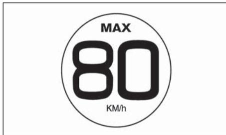
Наклейка на запасном колесе (для некоторых вариантов исполнения автомобиля)
