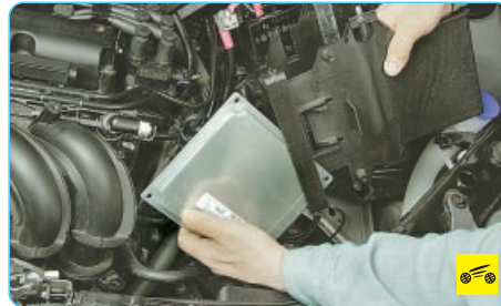
14. ...выведите контроллер из кронштейна на полке и отведите контроллер в сторону.
