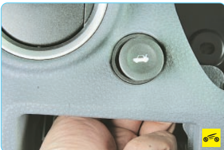
5. Через образовавшийся проем надавите рукой на выключатель электропривода замка багажника...
