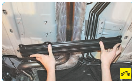
5. ...и снимите поперечину кузова.
