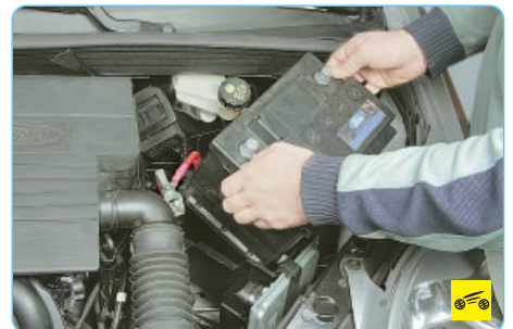
1. Снимите аккумуляторную батарею (см. «Снятие и установка аккумуляторной батареи», с. 211).
