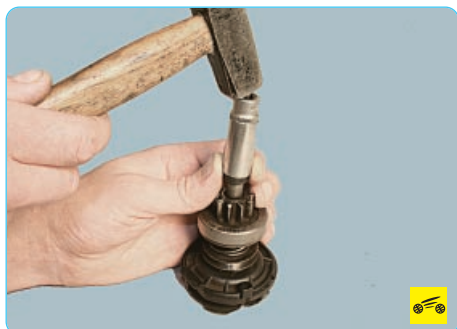
19. Сдвиньте по валу планетарного редуктора ограничительное кольцо...
