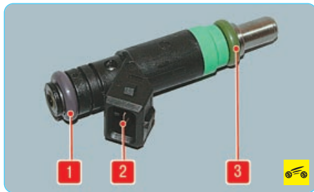
Рис. 5.39. Форсунка системы впрыска топлива: 1 – верхнее уплотнительное кольцо; 2 – штекерные выводы обмотки электромагнита; 3 – нижнее уплотнительное кольцо
