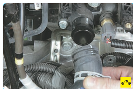
28. Аналогичным способом отсоедините подводящий шланг радиатора от отводящего патрубка водяной рубашки двигателя.
