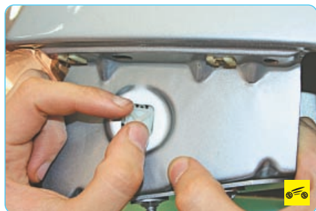
7. Сдвиньте блок-фару вбок, выведите фиксатор из отверстия в крыле...
