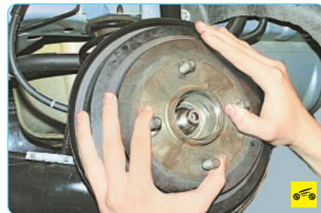
9. Снимите тормозной барабан.
