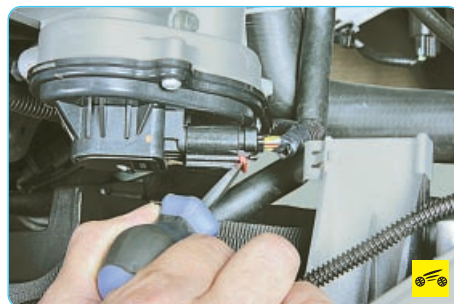
12. Сдвиньте вверх фиксатор...
