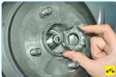
8. ...и снимите стопорную шайбу.
