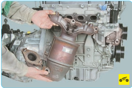
9. ...а затем снимите катколлектор..
