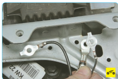
14. ...и отсоедините от кузова три провода «массы» моторного жгута проводов.
