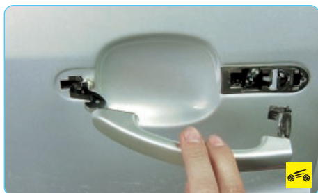
7. Сдвиньте наружную ручку назад и снимите ее, выведя ее поводок из зацепления с рычагом замка, а передний фиксатор – из зацепления с усилителем двери.
