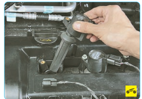
2. Снимите катушки зажигания (см. «Снятие и установка катушек зажигания двигателя Duratec-HE объемом 2,0 л», с. 226).
