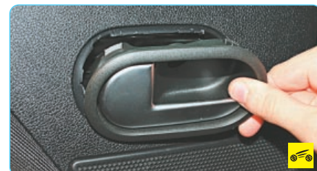
4. Подденьте корпус ручки отверткой, отведите внутреннюю ручку в сторону...
