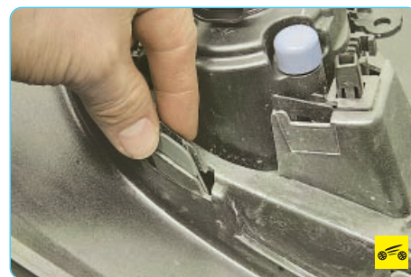
5. Отожмите фиксаторы декоративной накладки противотуманной фары...
