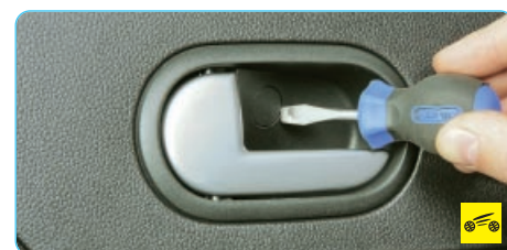
1. Подденьте отверткой заглушку винта крепления внутренней ручки...
