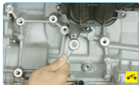
9. Выверните восемь болтов крепления впускного коллектора...
