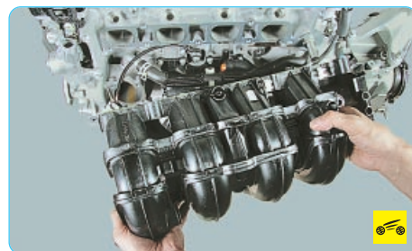
10. ...и снимите впускной коллектор в сборе с дроссельным узлом.
