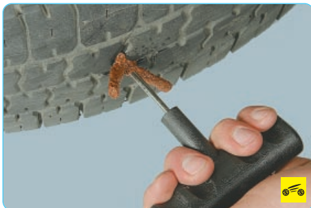
10. Нажатием на рукоятку иглы протолкните жгут в отверстие так, чтобы снаружи остались оба конца жгута длиной около 10 мм.
