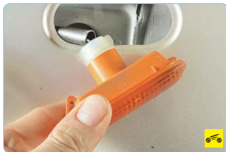
4. ...и извлеките фонарь указателя поворота из отверстия в крыле.
