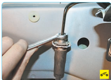
5. Отверните гайку крепления трубки и отсоедините трубку.
