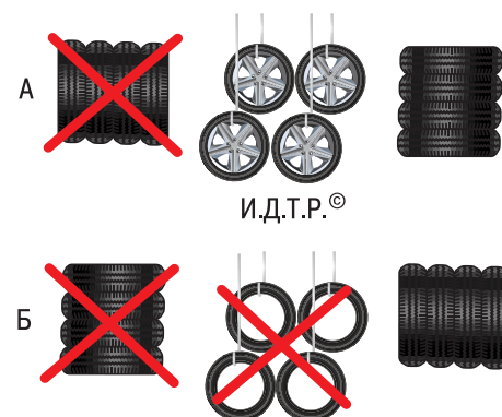
Рис. 14.5. Способы хранения шин: А – хранение колес в сборе с шинами; Б – хранение шин
