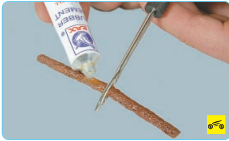
8. Нанесите на жгут слой клея из набора. Поверхность отверстия в шине также обработайте клеем.
