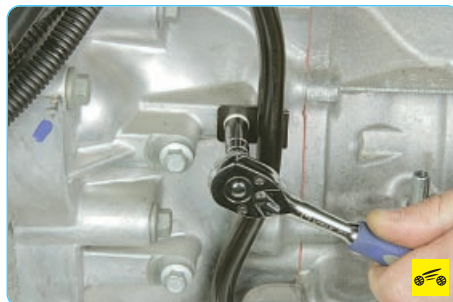
21. Выверните болт крепления направляющей трубки указателя (щупа) уровня жидкости...
