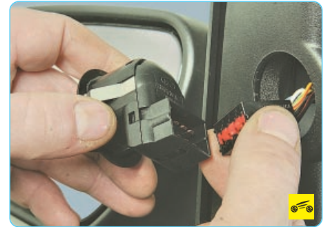
4. Отжав фиксатор, отсоедините колодку жгута проводов от блока управления.
