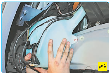
9. ...и извлеките бачок омывателя из полости крыла.
