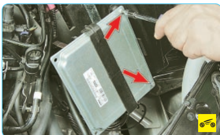
13. ...два винта крепления контроллера (ЭБУ) системы управления двигателем...
