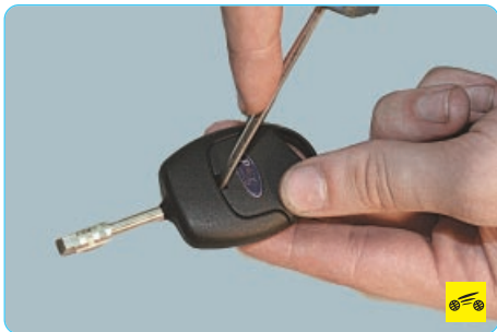
1. Отожмите отверткой фиксатор...
