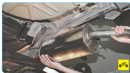
8. ...и извлеките глушители, аккуратно выводя их через проем между основанием кузова и балкой задней подвески.
