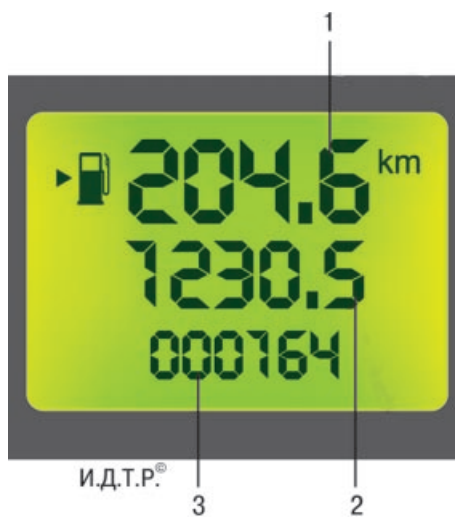
Рис. 1.10 Индикаторы маршрутного компьютера без функции вывода предупредительных и информационных сообщений: 1 – запас хода по топливу или показания часов (по выбору); 2 – счетчик суточного пробега; 3 – одометр
