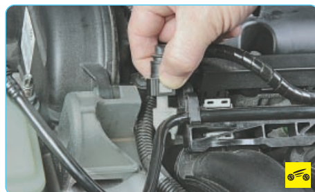
22. Сжав фиксаторы, отсоедините от топливной рампы трубопровод подачи топлива.
