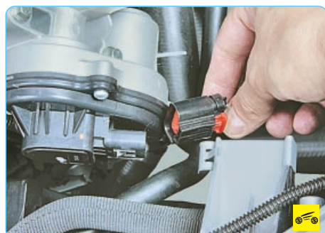
4. Сдвиньте вверх фиксатор...
