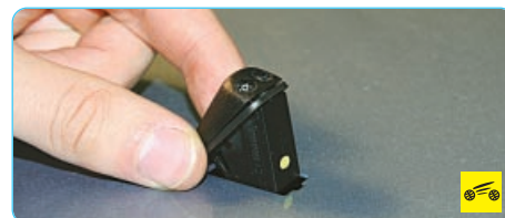
19. ...и извлеките жиклер омывателя из отверстия в капоте.
