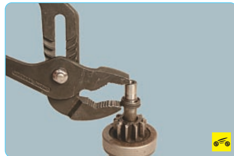
3. Для установки ограничительного кольца воспользуйтесь раздвижными пассатижами.
