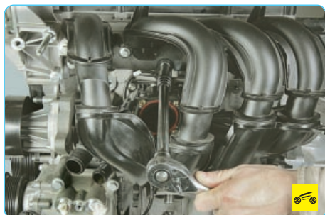
13. Выверните шесть болтов крепления впускного коллектора...
