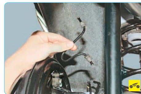
4. ...и отсоедините трубку. 5. Установите новую трубку в порядке, обратном снятию.
