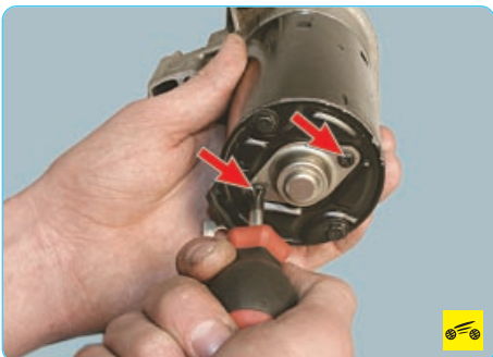
6. Выверните два винта крепления крышки подшипника...
