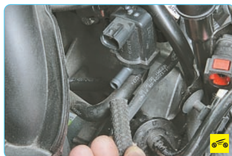
23. Отсоедините трубопровод от клапана продувки адсорбера.
