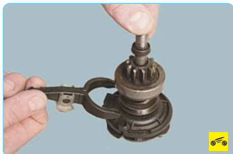
18. Снимите рычаг привода.
