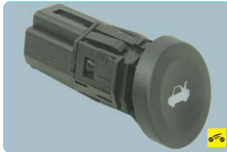
9. Установите выключатель электропривода замка багажника в порядке, обратном снятию.
