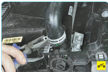
7. Сжав пассатижами отогнутые ушки хомута, сдвиньте его по шлангу...
