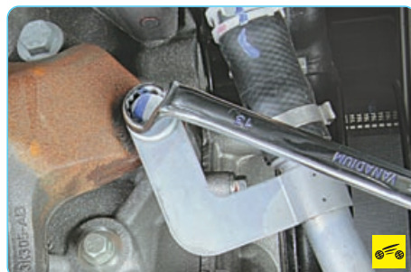
20. Выверните болты крепления к двигателю кронштейнов трубопроводов гидросилителя рулевого управления.
