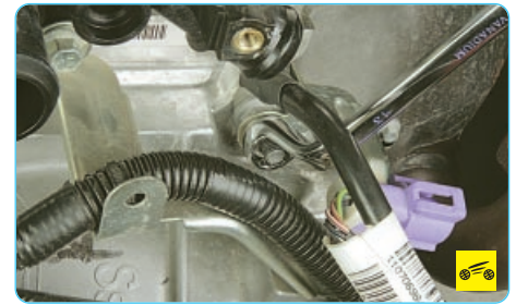
24. Отверните гайку шпильки крепления монтажного кронштейна крепления жгутов к картеру коробки передач...
