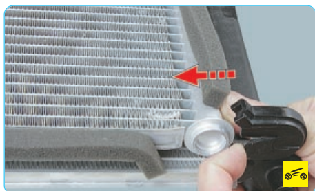
16. ...и, сдвинув радиатор вдоль полозьев конденсора, аккуратно разъедините радиатор и конденсор.
