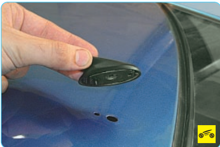
5. ...и снимите кронштейн антенны.
