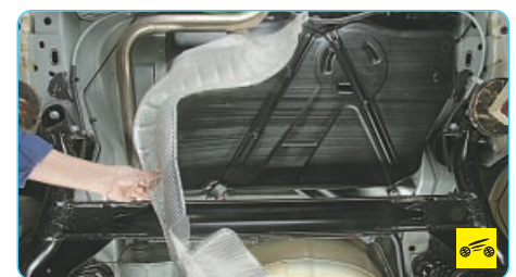
4. ...и снимите задний термоэкран.
