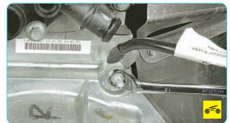
27. Выверните верхнюю шпильку крепления картера коробки передач к двигателю...
