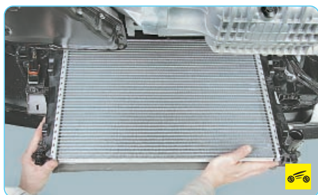
14. Приподнимите блок радиаторов, извлеките его из посадочных мест и опустите вниз, насколько позволяют шланги конденсора.
