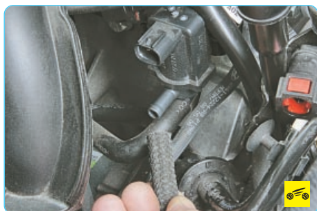
12. ...и трубопровод адсорбера.
