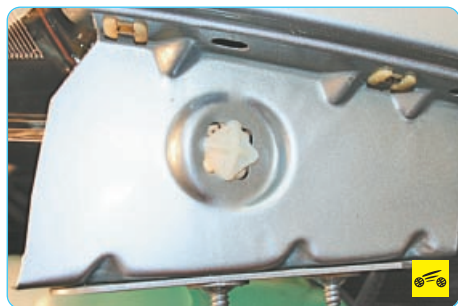
6. Поверните на 45° в любую сторону пластиковый фиксатор крепления блок-фары к крылу.
