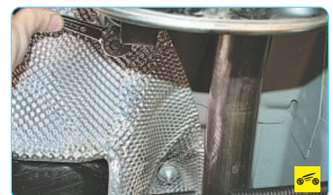
3. Отверните две гайки крепления в задней части кузова...
