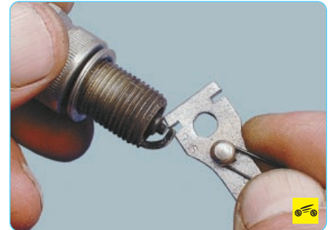
7. Если зазор отличается от указанного значения, отрегулируйте его, подгибая боковой электрод.
