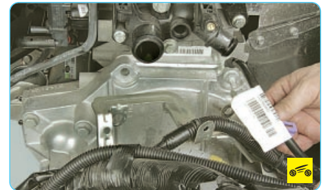
26. ...и снимите монтажный кронштейн (для наглядности сняты шланги с патрубков водораспределителя).
