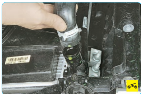
8. ...и снимите отводящий шланг с патрубка радиатора.
