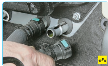
26. Сжав фиксаторы, отсоедините два шланга от патрубков отопителя салона.
