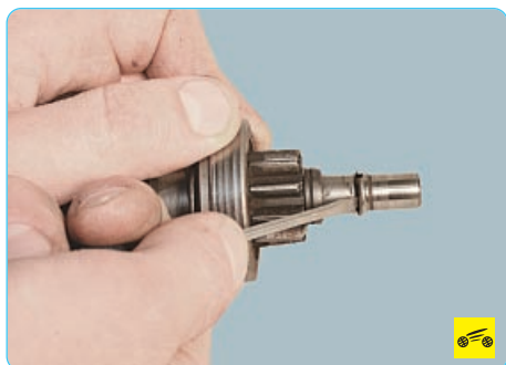
20. ...и снимите стопорное кольцо, поддев его отверткой.
