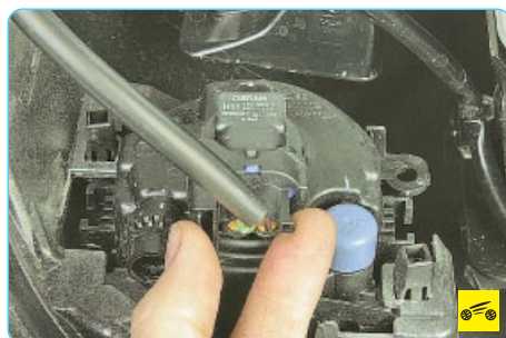
3. Сожмите фиксатор колодки жгута проводов...
