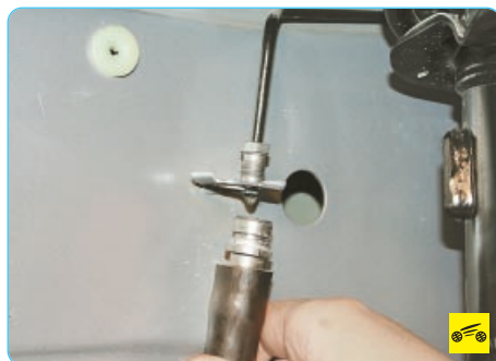
7. Извлеките наконечник шланга из отверстия кронштейна на кузове.
