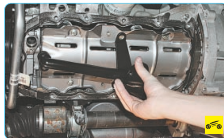
Рис. 5.35. Порядок затяжки болтов крепления масляного насоса
