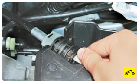
Рис. 6.4. Разрезание шумоизоляционной обивки тоннеля пола для получения доступа к креплению уплотнителя тросов управления коробкой передач
