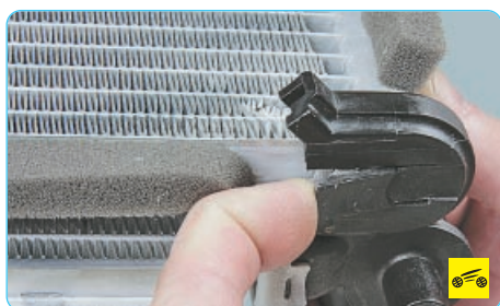
15. Отожмите фиксатор у левой нижней опоры крепления радиатора...
