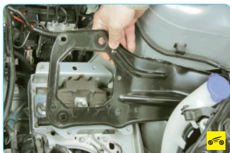
8. ...и снимите кронштейн крепления аккумуляторной полки.
