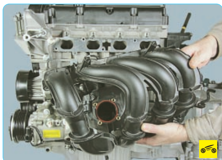
14. ...и снимите впускной коллектор.
