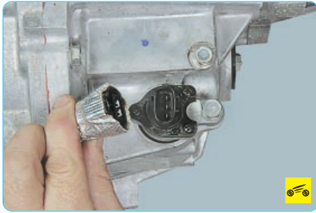
14. Аналогичным способом отсоедините колодку жгута проводов от датчика скорости.
