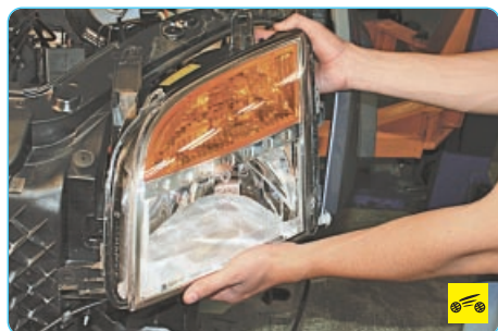
8. ...и снимите блок-фару. 9. Установите блок-фару и все ранее снятые детали в обратном порядке.
