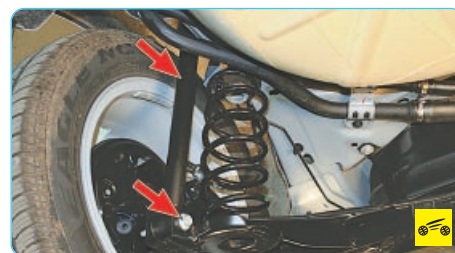
Рис. 7.4. Задняя подвеска (с задними тормозными механизмами барабанного типа): 1 – опора амортизатора задней подвески; 2 – буфер сжатия; 3 – амортизатор задней подвески; 4 – прокладка пружины задней подвески; 5 – пружина задней подвески; 6 – сайлентблок; 7 – балка задней подвески
