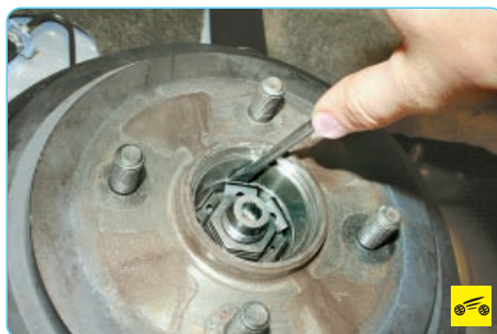
6. Отогните пластины стопорной шайбы гайки ступицы.
