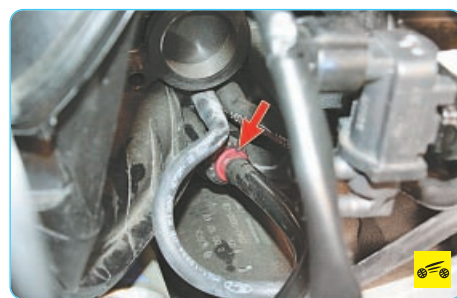
28. Аналогичным способом отсоедините подводящий шланг радиатора от отводящего патрубка водяной рубашки двигателя.
