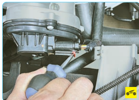
4. Сдвиньте вверх фиксатор...
