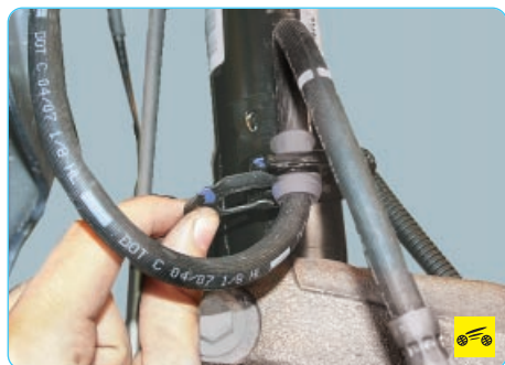
3. ...снимите фиксатор крепления шланга к кронштейну на амортизаторной стойке...
