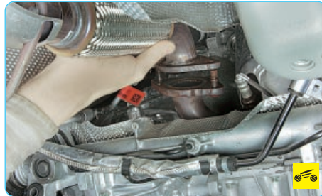
3. ...и снимите фланец приемной трубы со шпилек.
