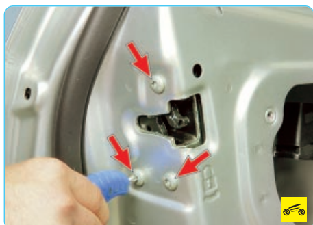
10. ...выверните три винта крепления замка двери с заднего торца двери...
