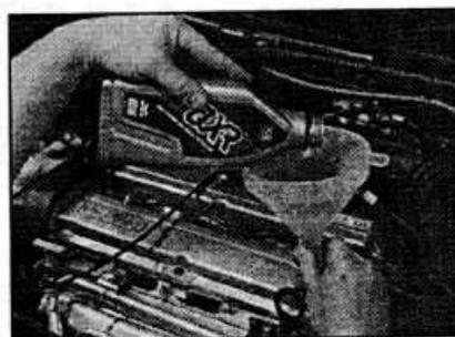
**4** При необходимости долейте масло через крышку заливной горловины моторного масла.
