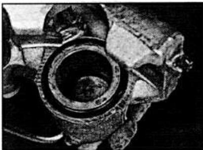
Рис. 9.17. Расположение поршня и пылезащитного чехла в суппорте.
