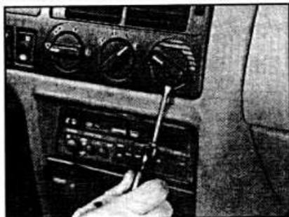
Рис. 3.42. Снятие ручек управления отопителем с помощью рычага.
