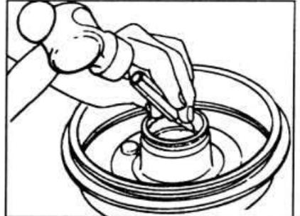
Рис. 10.28. Выбивание наружного кольца конического подшипника из задней ступицы с помощью соответствующей выколотки.
