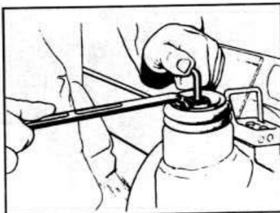
Рис. 10.12. Отвинчивание центральной гайки крепления стойки передней подвески.
