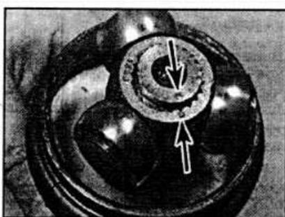
Рис. 8.12. Расположение меток совмещения на приводном валу и шарнире.
