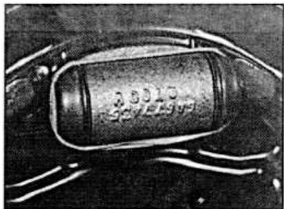
Рис. 9.26. Фиксация поршней рабочего тормозного цилиндра резинкой.
