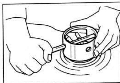
Рис. 4A.20. Отвинчивание крышки датчика уровня топлива с помощью специального инструмента FORD 23-014.
