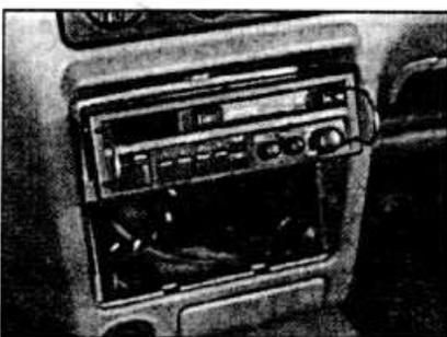
**Рис. 12.71.** Снятие радиоприемника.
