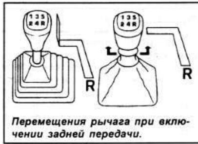
Перемещения рычага при включении задней передачи.
