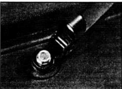
Рис. 12.58. Гайка крепления рычага стеклоочистителя.
