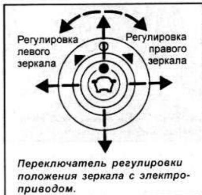
качаться и поворачиваться. Для регулировки положения левого зеркала, поверните переключатель против часовой стрелки и, наклоняя переключатель, отрегулируйте положение зеркала, после чего установите переключатель в центральное положение. Регулировку положения правого зеркала произведите аналогично, только переключатель необходимо повернуть по часовой стрелке.
