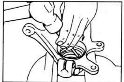
Рис. 10.9. Выбивание наружного кольца подшипника из поворотного кулака с помощью выколотки.
