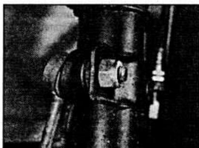
**Рис. 10.18. Крепление тяги стабилизатора к стойке передней подвески.**
