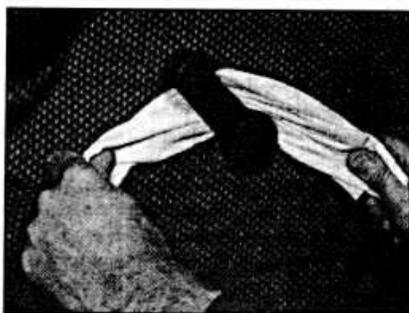
Рис. 11.14. Освобождение скобы крепления ручки стеклоподъемника с помощью ткани.
