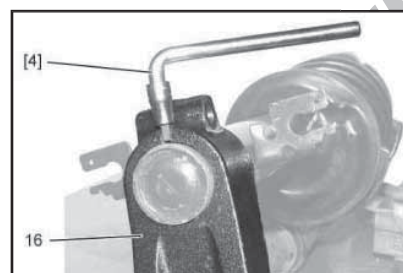
4.9 Снятие поворотного кулака (16) с помощью специального приспособления [4]
