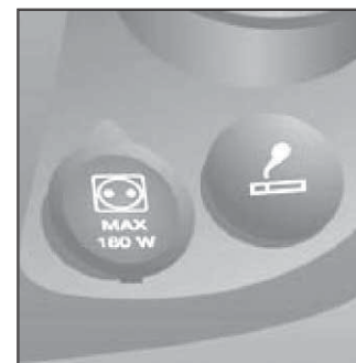
13.11 Розетка отбора мощности и прикуриватель в панели приборов
