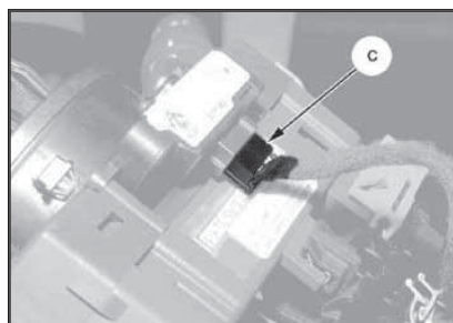
27.1a Разъём (с) электропроводки датчика угла поворота рулевого колеса
