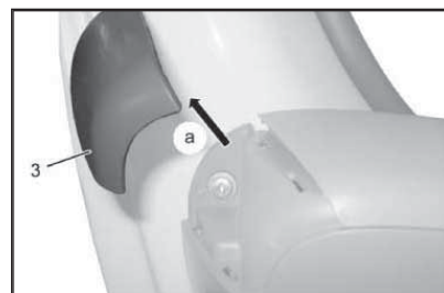
3.21 Снятие верхней панели (3) внутренней отделки передней двери
