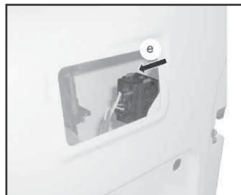
3.43 Разъём (e) электропроводки замковой сборки правой двери задка
