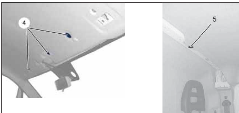
11.6 Фиксаторы (4, 5) панели потолочной обивки
