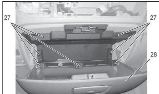
15.19 Болты (27) крепления крышки главного вещевого ящика (28)
