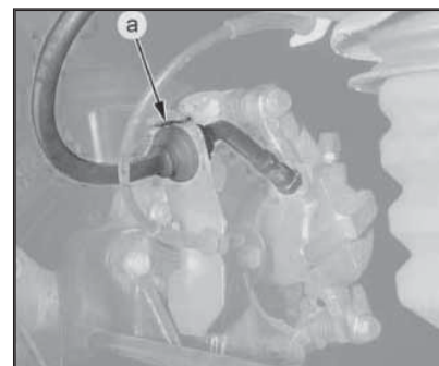
5.8 Фиксатор (а) крепления тормозного шланга на суппорте тормозного механизма заднего колеса
