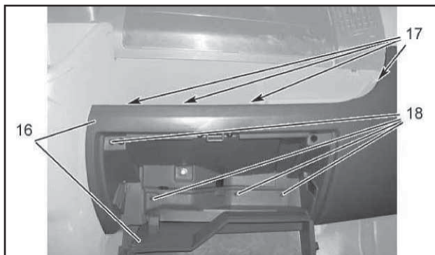
15.12 Болты (17, 18) крепления главного вещевого ящика (16)
