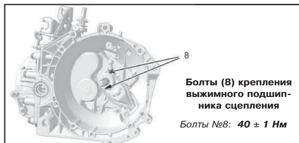
Болты крепления картера коробки передач (BVM6)
