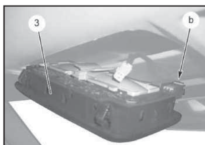
17.4 Разъём (b) электропроводки переднего светильника (3)
