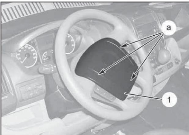
26.3 Фиксаторы (а) крепления крышки (1) модуля фронтальной водительской подушки безопасности
