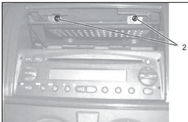
15.2 Болты (2) крепления панели приборов
