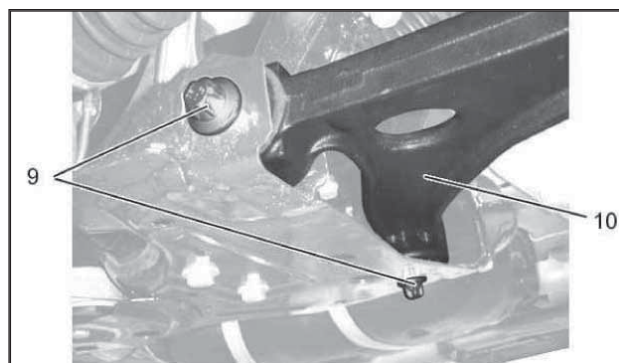
7.6 Болты (9) крепления управляющего рычага (10)
