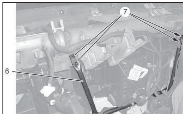
14.31 Болты (7) крепления поперечной балки (6) панели приборов
