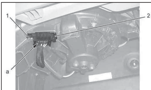
22.1 Детали установки элемента (2) управления скоростью работы нагнетающего вентилятора
