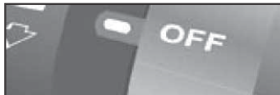
22.4 Деактивация темпостата осуществляется путём перевода дополнительного левого подрулевого переключателя в положение OFF
