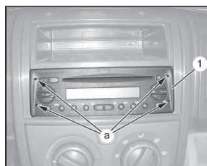
18.2 Фиксаторы (а) крепления аудиосистемы (1)
