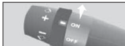
22.3 Изменение значений выбранной крейсерской скорости производится отжимания дополнительного левого подрулевого переключателя в соответствующее положение: "+" (ускорение) или "-" (замедление)
