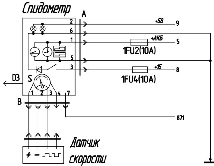
*Подключение спидометра и цифрового тахографа*
