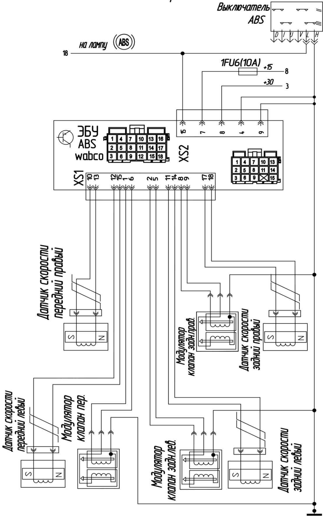
Рис.7-16 Схема электрооборудования автобуса ПАЗ-32053 (Лист 5)
