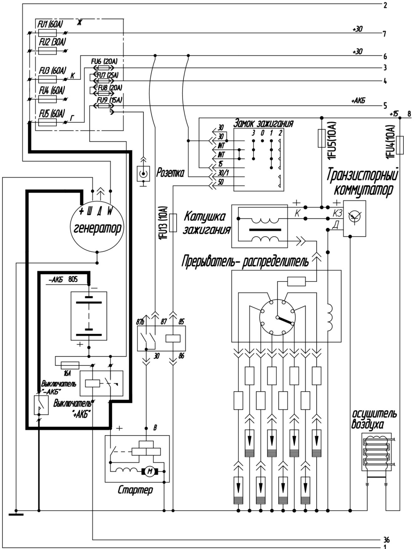
Рис. 7-16 Схема электрооборудования автобуса ПАЗ-32053 (Лист 11)
