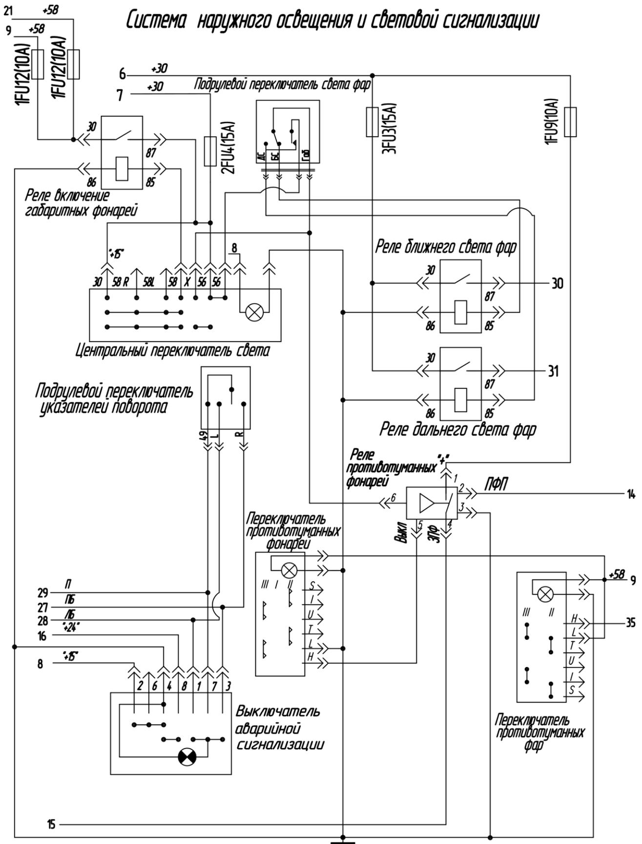
Рис. 7-16 Схема электрооборудования автобуса ПАЗ-32053 (Лист 2)
