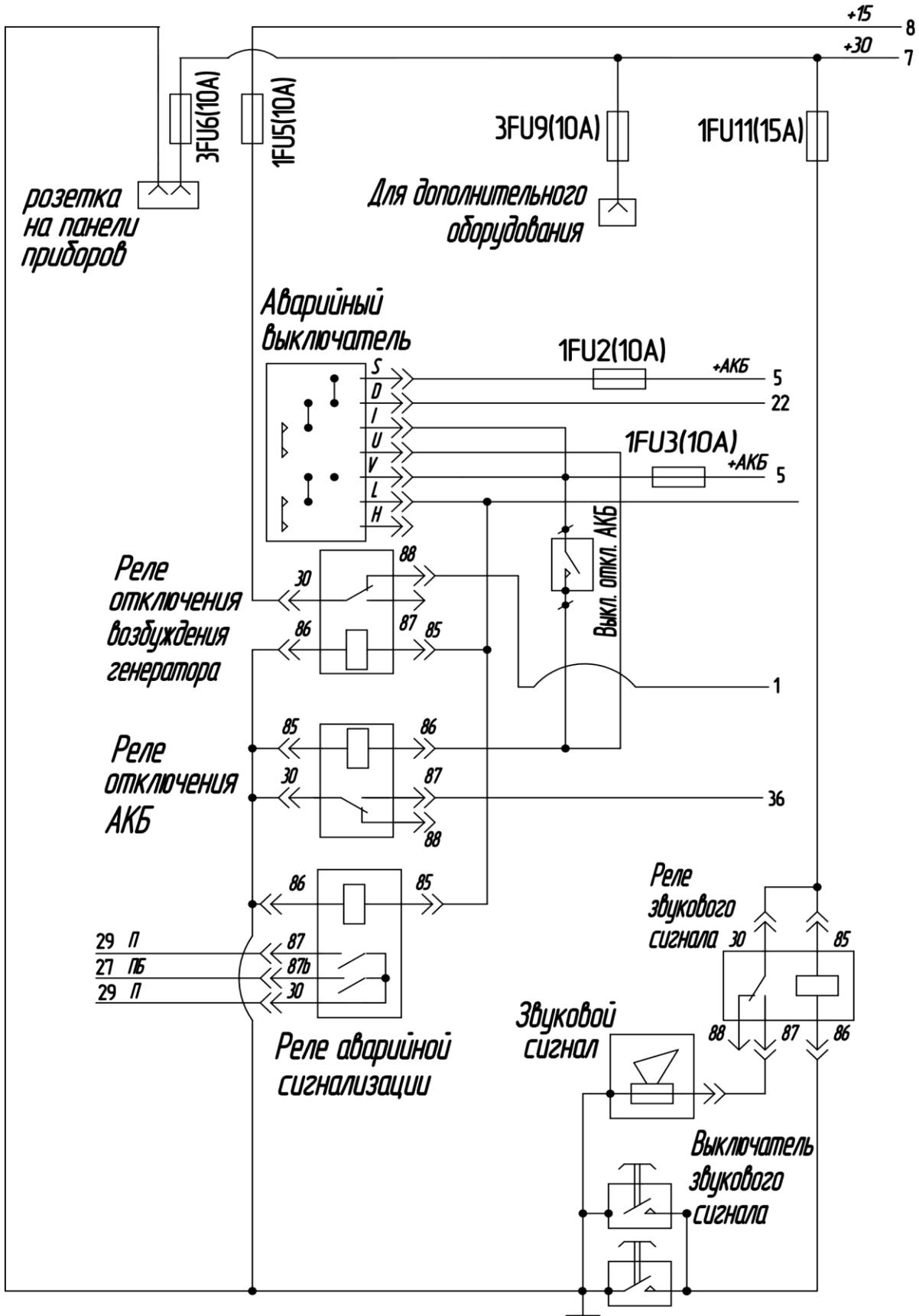
Рис. 7-16 Схема электрооборудования автобуса ПА3-32053 (Лист 4)
