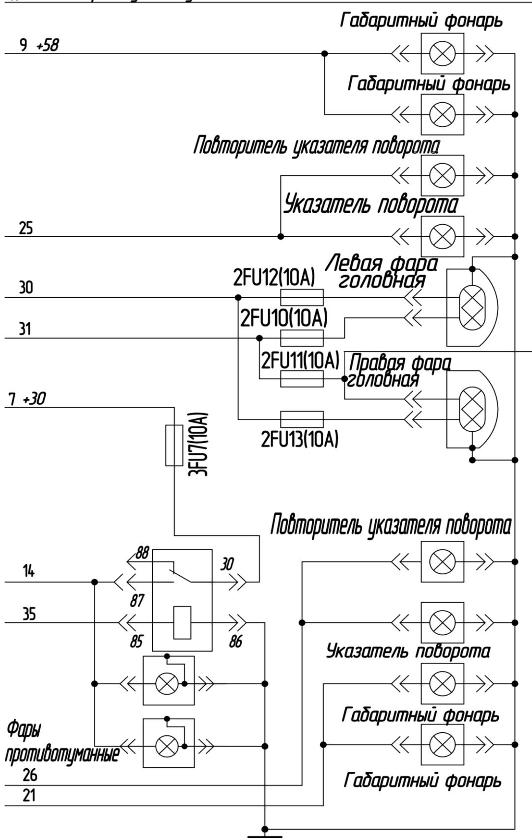
Рис. 7-16 Схема электрооборудования автобуса ПАЗ-32053 (Лист 3)
