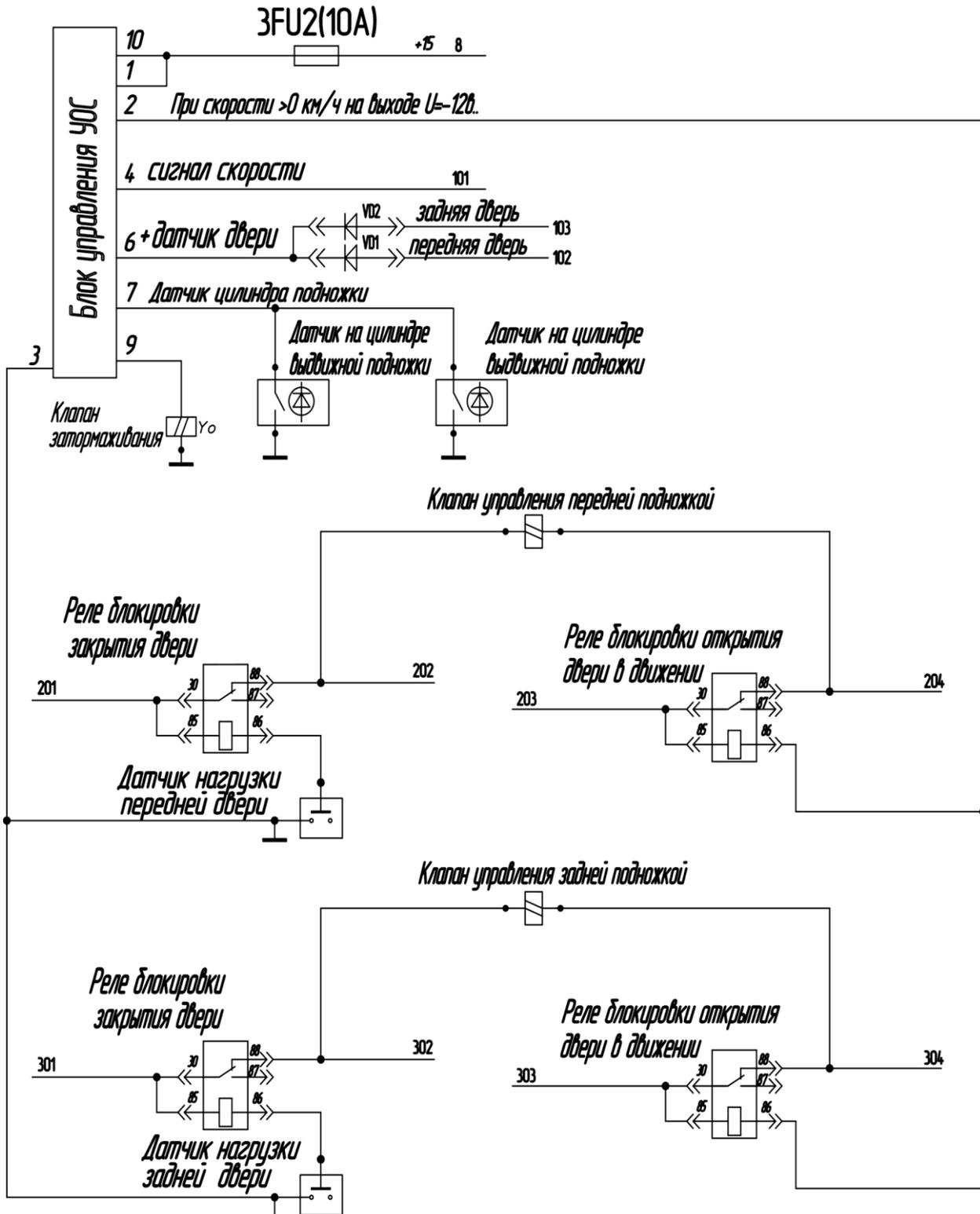
Рис. 7-16 Схема электрооборудования автобуса ПА3-32053 (Лист 7)
