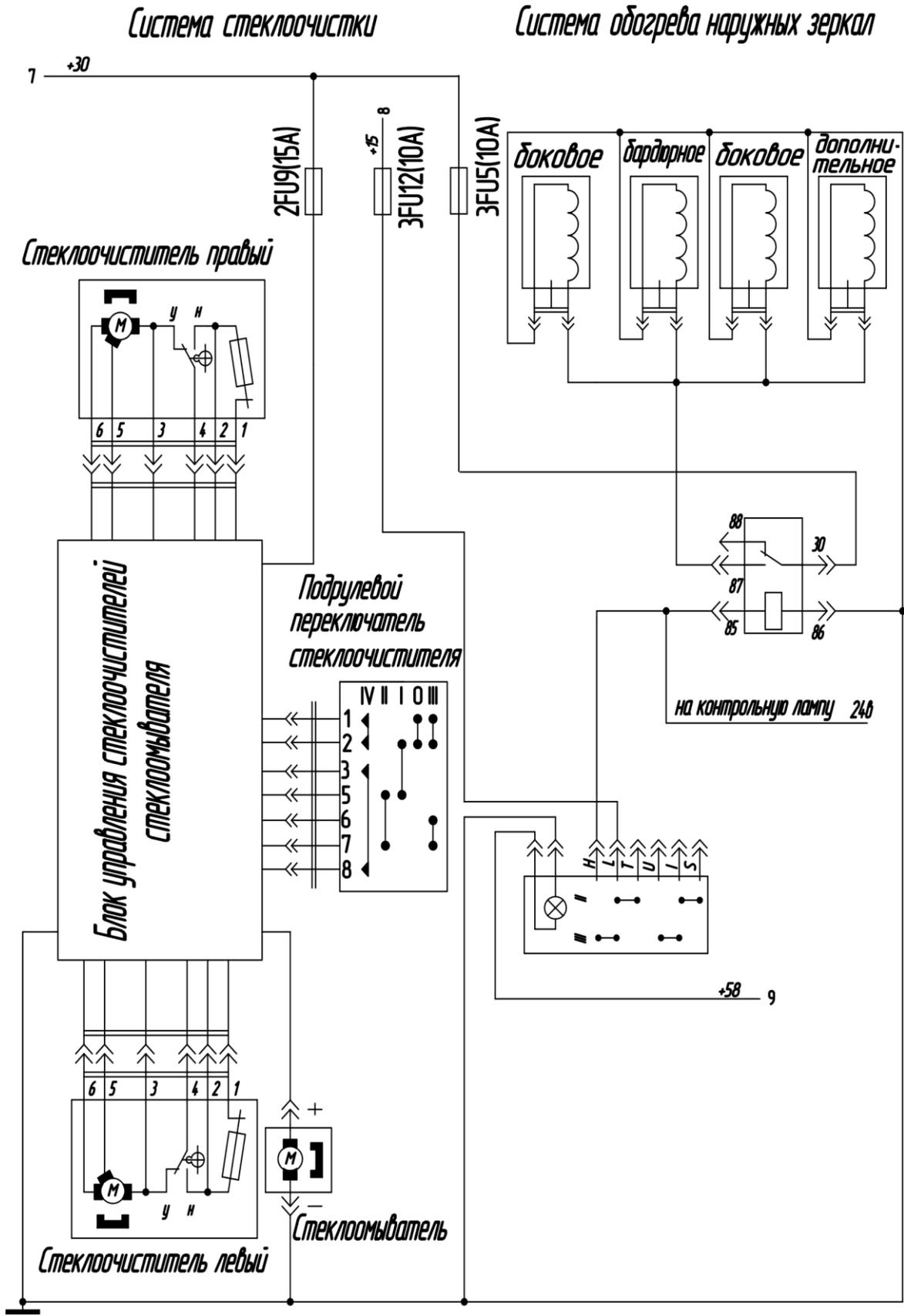
Рис.7-16 Схема электрооборудования автобуса ПА3-32053 (Лист 10)
