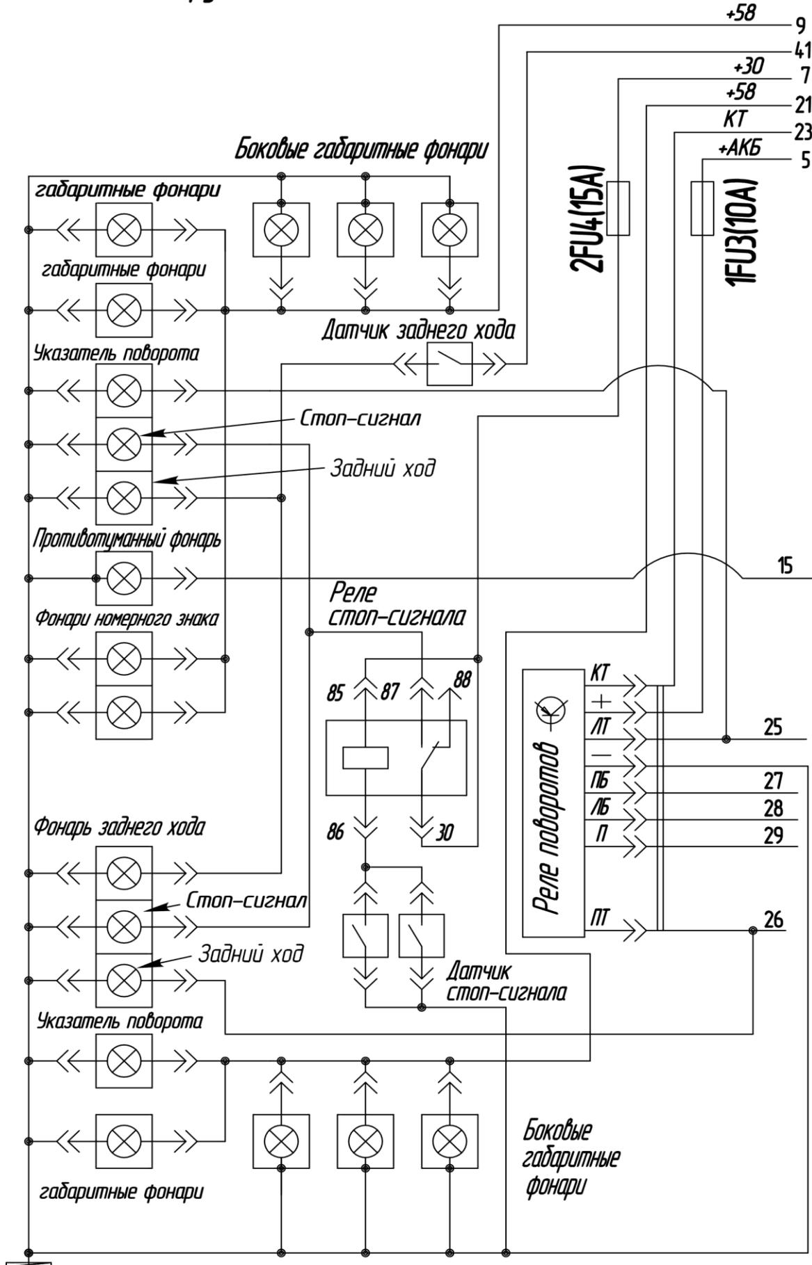
Рис. 7-16 Схема электрооборудования автобуса ПАЗ-32053 (Лист 1)
