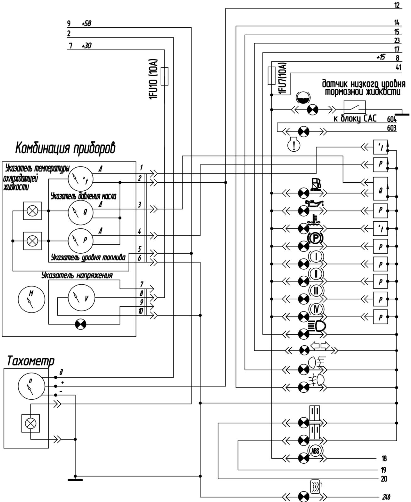
Рис. 7-16 Схема электрооборудования автобуса ПАЗ-32053 (Лист 12)
