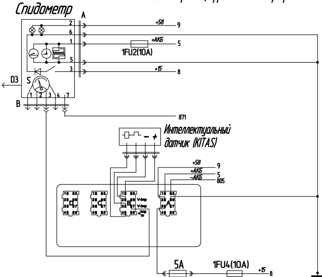
Рис.7-16 Схема электрооборудования автобуса ПАЗ-32053 (Лист 13)
