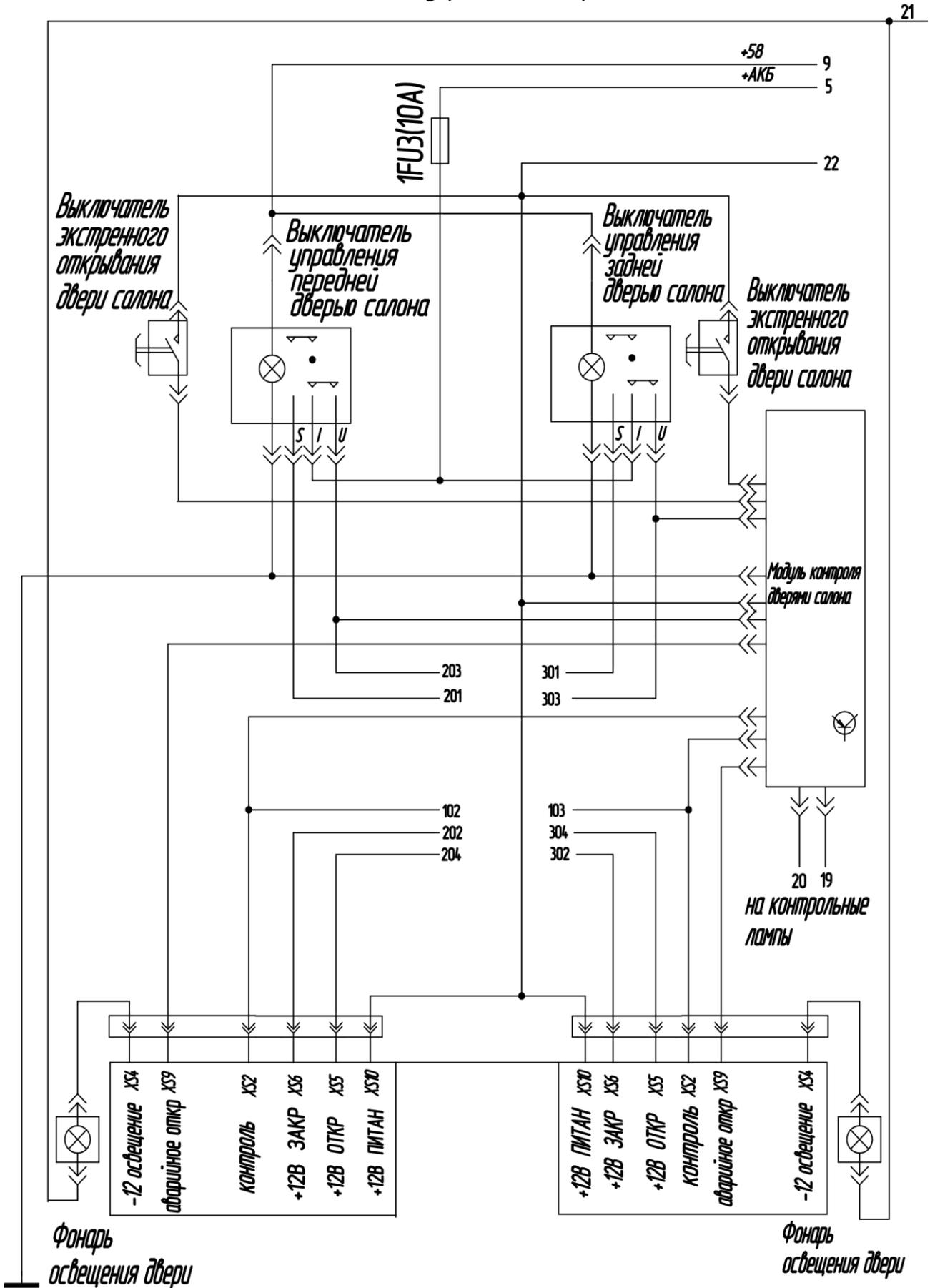
Рис. 7-16 Схема электрооборудования автобуса ПАЗ-32053 (Лист 8)
