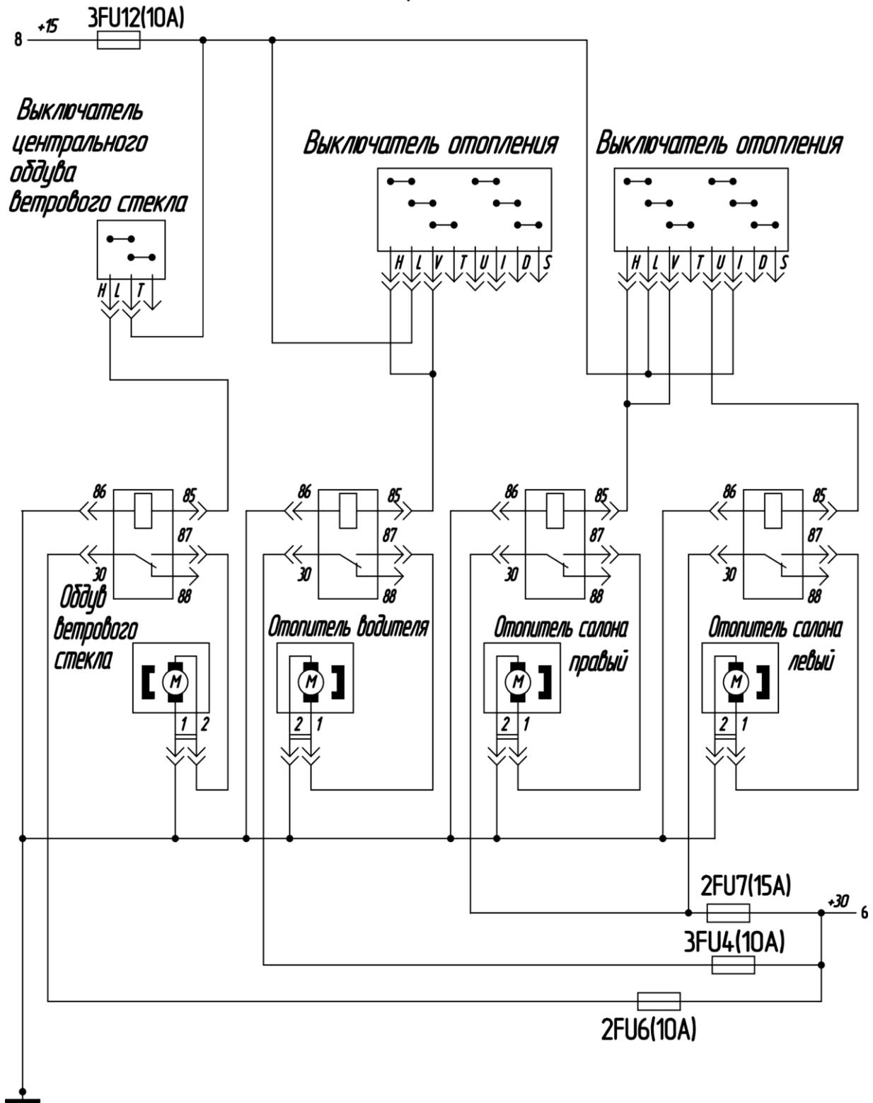
Рис. 7-16 Схема электрооборудования автобуса ПАЗ-32053 (Лист 9)
