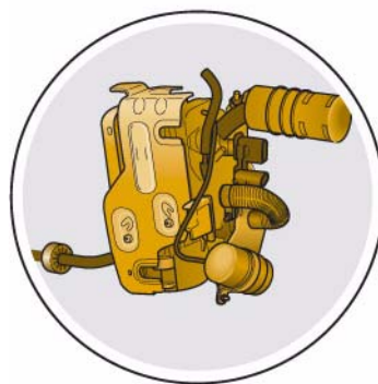
Блок управления отопителем J162, под передним правым крылом
