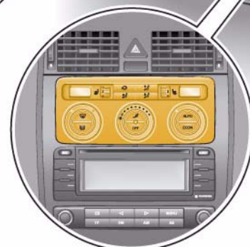
Блок управления системой Climatronic J255, в центральной консоли
