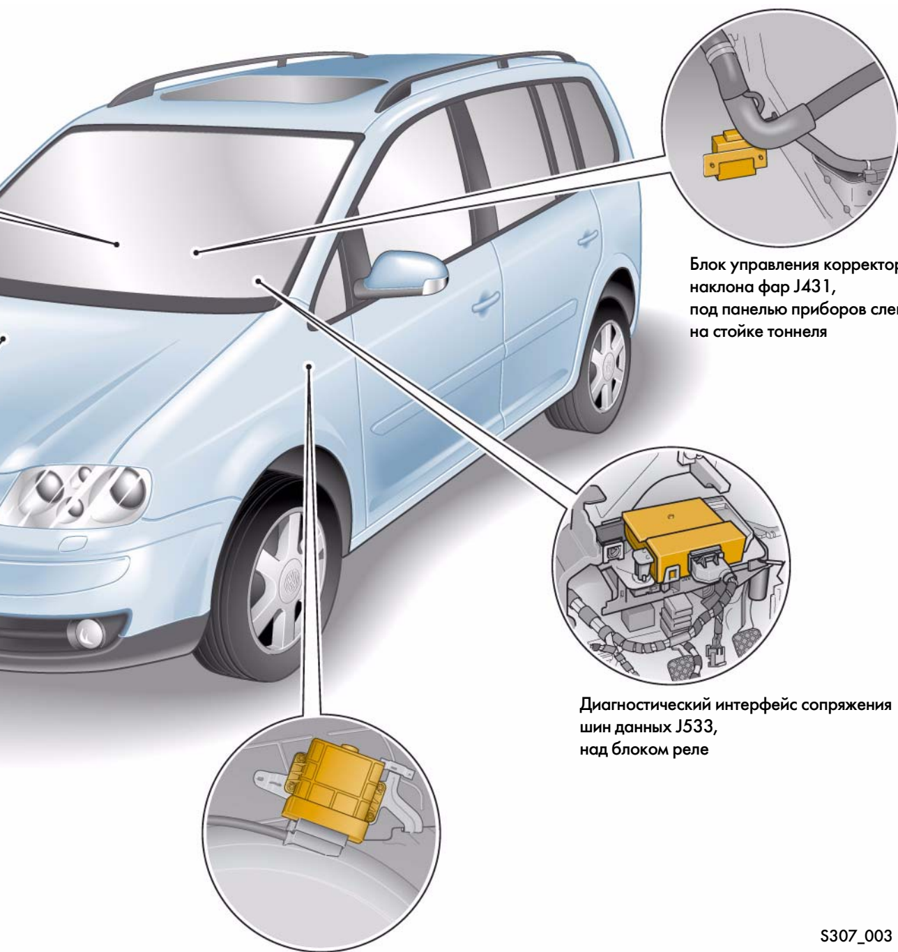
Блок управления автоматической коробкой передач J217, в нише колеса
