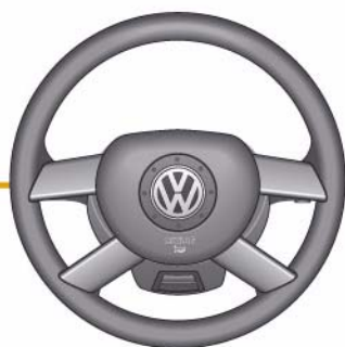
Органы управления на рулевом колесе (E221), являющийся ведомым блоком управления шины LIN
