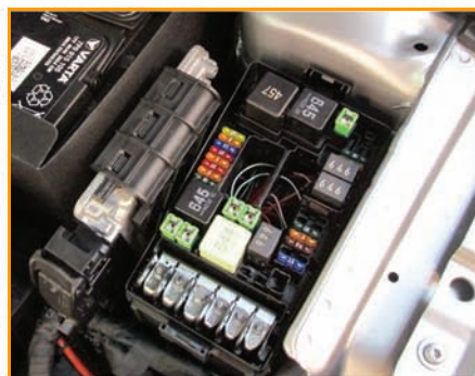
Коммутационный блок с блоком реле и предохранителей SB и блоком главных предохранителей Multifuse SA
