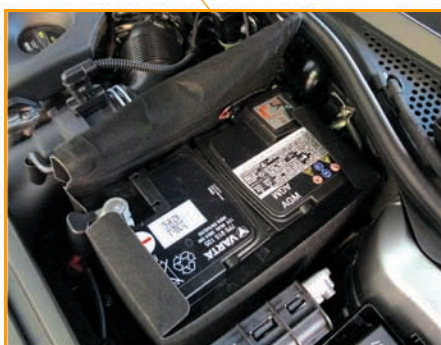
АКБ 12 В в моторном отсеке
