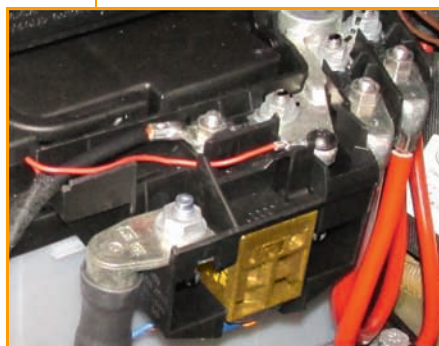
Главный блок предохранителей с блоком предохранителей SD, положительной клеммой и главным выключателем АКБ J990
