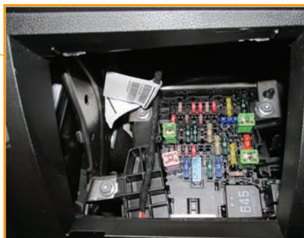
Блок реле и предохранителей SC в салоне внизу слева, за вещевым отсеком
