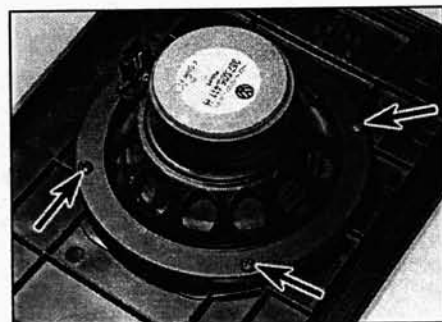
Рис. 21.5,в. Динамик для воспроизведения низких частот, устанавливаемый в двери автомобиля (стрелками показаны винты его крепления) (ранние модели)
