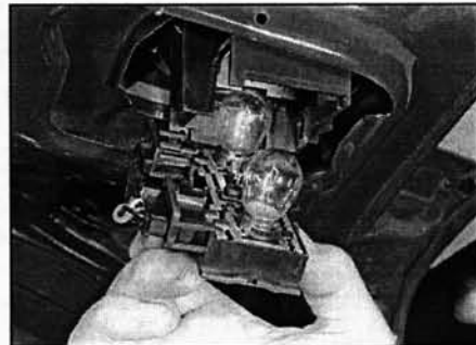
Рис. 7.34,б. Снятие заднего блока фонарей из крышки багажника – седан
