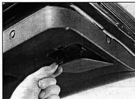
Рис. 7.44. Откройте лючок в крышке багажника или в пятой двери...
