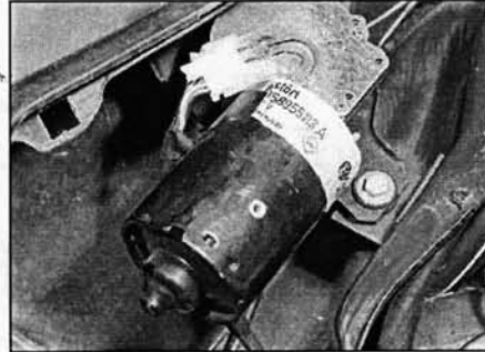
Рис. 13.8. Электродвигатель стеклоочистителя и его электрический разъём
