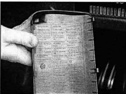
Рис. 3.3,б. Перечень предохранителей и цепей, которые они защищают
