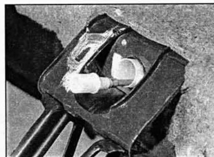
Рис. 10.8,в. Наконечник троса спидометра
