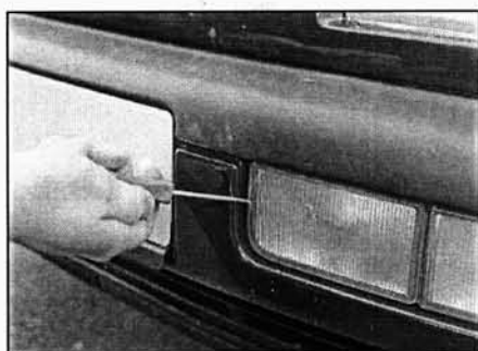
Рис. 7.19. Подцепите отвёрткой декоративную панель (показано для моделей без передних противотуманных фонарей)
