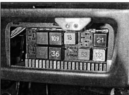
Рис. 3.3,а. Блок реле и предохранителей
