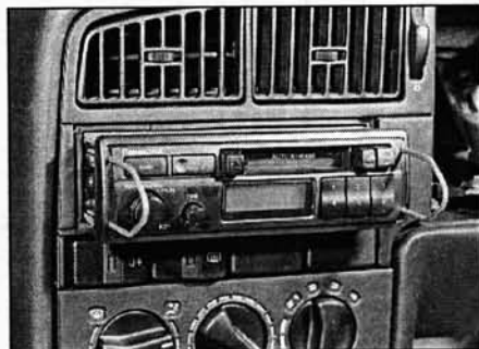
Рис. 19.3. Вставьте стержни по бокам магнитолы так, чтобы отжать пружинные фиксаторы
