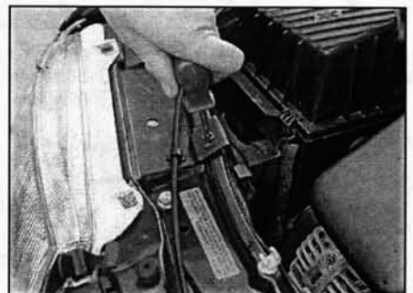
Рис. 7.7,в. Если меняете лампочку дальнего света, то отверните винт крышки...
