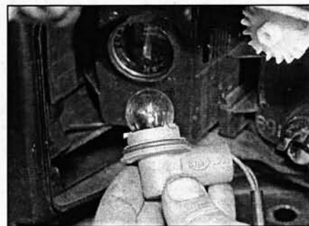
Рис. 7.15. Патрон переднего указателя поворота (ранние модели)
