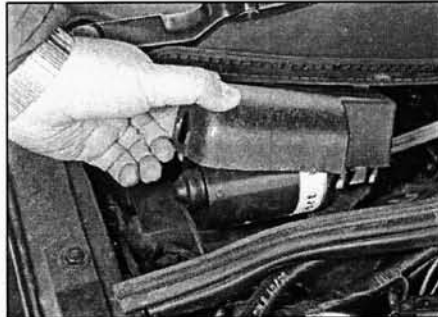
Рис. 13.7. Пластиковая крышка электродвигателя стеклоочистителя
