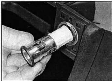
Рис. 12.3,б. ...и выньте прикуриватель
