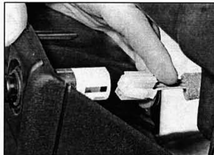
Рис. 12.1. Отсоединит электрический разъём...
