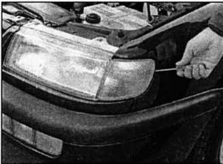
Рис. 9.6. Выньте боковой рассеиватель
