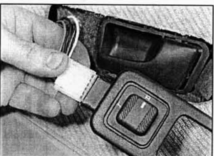
Рис. 6.9. Снятие выключателя регулировки бокового зеркала заднего вида
