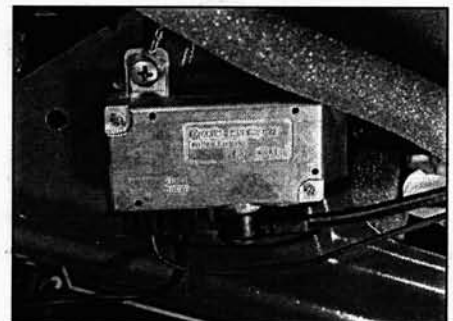
Рис. 20.8. Усилитель сигнала антенны, устанавливаемой в заднем стекле
