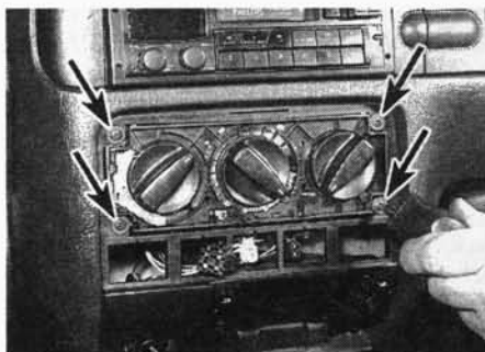
Рис. 11.2,б. ... затем выверните четыре крепежных винта панели управления (отмечены стрелками)
