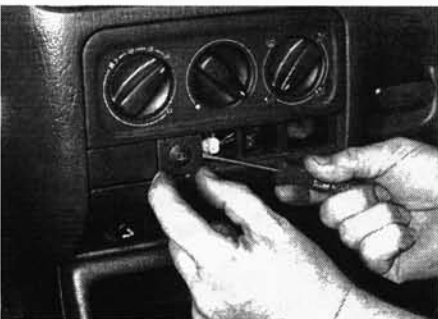
Рис. 4.11. Извлечение выключателя обогрева заднего окна
