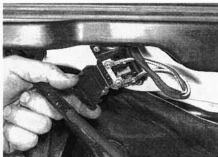
Рис. 3.8. Плавкая вставка цепи питания накаливающей лампы дизельного двигателя (показана одна из первых моделей)
