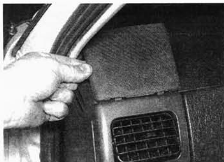
Рис. 19.1. Отсоедините крышку динамика в верхней части приборной панели ...
