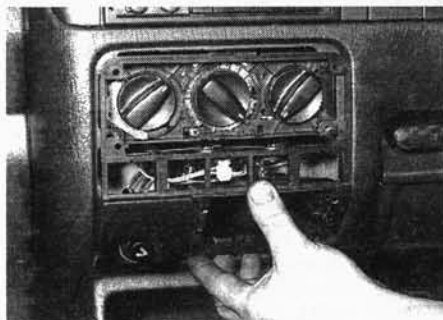
Рис. 11.6,а. ... затем извлеките панель выключателей из лицевой панели
