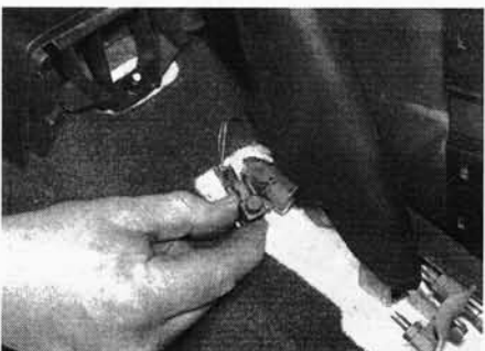
Рис. 4.29. Отсоедините переключатель стояночного тормоза от рычага и разъедините разъем электропроводки
