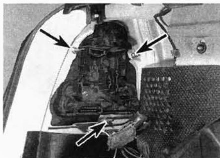
Рис. 7.16,а. ... затем отверните гайки (отмечены стрелками) ...
