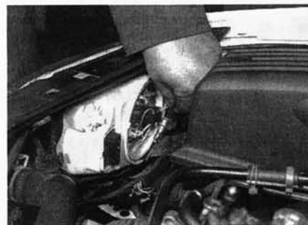
Рис. 5.9,а. Извлеките патрон габаритного огня из задней части блока фары ...
