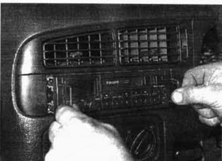
Рис. 18.3,а. На автомобилях, изготовленных до 1994 г.: вставьте приспособления для снятия ...
