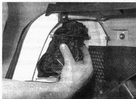
Рис. 5.27. ... затем нажмите на фиксаторы и извлеките блок ламп
