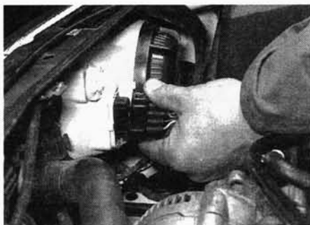
Рис. 7.2. Разъединение разъема электропроводки фары
