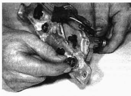
Рис. 15.7,а. Вывинтите два болта и отсоедините двигатель от кронштейна...
