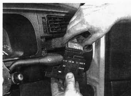
Рис. 4.7, б. ... и разъедините разъем электропроводки, когда он станет доступен
