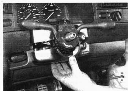
Рис. 4.3. Выверните винты и снимите верхний и нижний кожухи рулевой колонки
