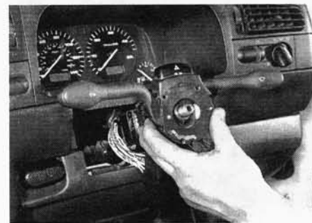
Рис. 4.4,б. ... затем снимите комбинированный выключатель
