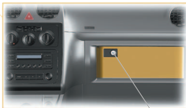
Вещевой ящик на стороне переднего пассажира с замком выключателя его подушки безопасности
