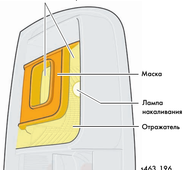
Корпус заднего фонаря без цветного рассеивателя
