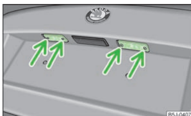
Илл. 150 Снятие лампы фонаря освещения номерного знака
