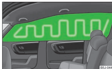
Илл. 102 Газонаполненная верхняя подушка безопасности
