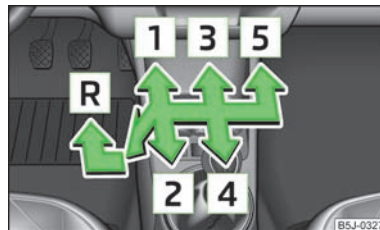
Илл. 79 Схема переключения 5-ступенчатой механической коробки передач (МКП).
