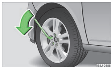
Илл. 130 Замена колеса: откручивание колёсных болтов
