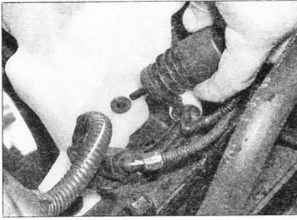
Рис. 20.8. Вытяните насос из уплотнительной втулки
