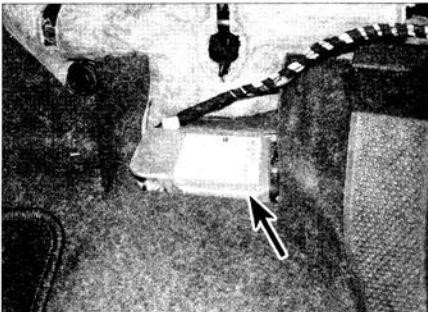
Рис. 26.17. Блок управления подушками безопасности, расположенный на туннеле (отопитель снят)
