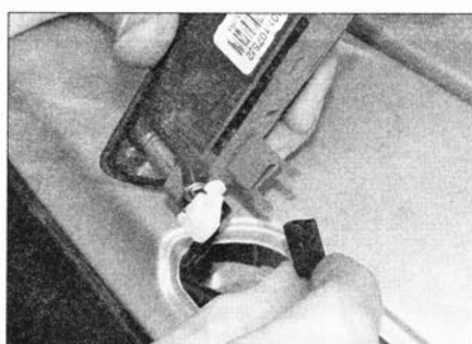
Рис. 5.58,в. ...разъедините электрический разъем...
