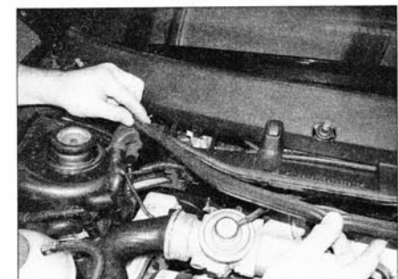
Рис. 18.2,а. Высвободите резиновую уплотнительную полосу...
