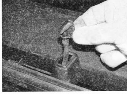
Рис. 20.11. Снятие форсунки омывателя с крышки накопительной камеры
