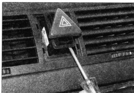
Рис. 4.42,б. ...извлеките выключатель...
