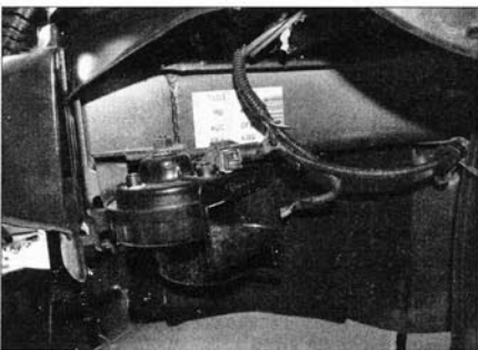
Рис. 15.3. Звуковые сигналы расположены за передним бампером
