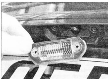
Рис. 5.61,б. Снимите рассеиватель...
