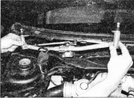
Рис. 18.3,б. ...извлеките электродвигатель и рычажный привод из проема...
