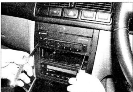
Рис. 21.7,а. Использование щупов для снятия CD-чейнджера
