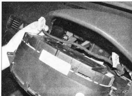
Рис. 10.4,в. ...и разъедините электрический разъем
