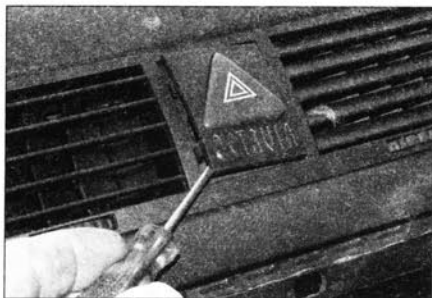
Рис. 4.42,а. Подденьте и снимите обрамление...
