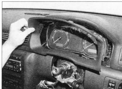
Рис. 10.3,б. ...и снимите обрамление щитка приборов
