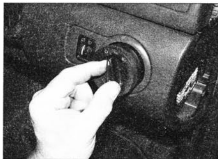
Рис. 4.10. Снимите переключатель освещения с лицевой панели...
