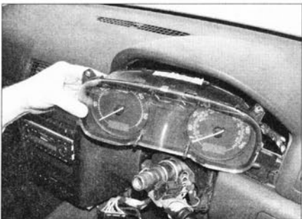
Рис. 10.4,б. ...извлеките щиток приборов...
