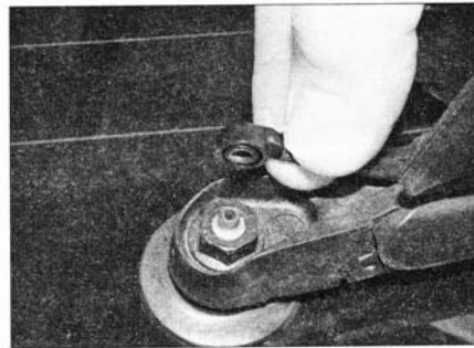
Рис. 17.5,в. ...чтобы снять переходник шланга омывателя с вала на моделях «хэтчбэк»
