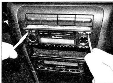
Рис. 21.3,а. Использование щупов для извлечения магнитолы
