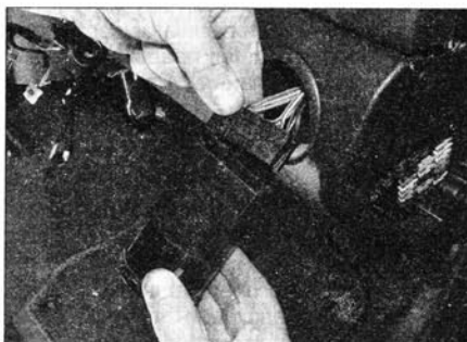
Рис. 4.11,а. ...и рассоедините соответствующий электрический разъем...
