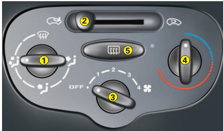
Распределение воздушных потоков можно по желанию изменить, установив переключатель 1 в промежуточное положение. Не зависимо от положения переключателя, всегда можно настроить воздуховоды.
