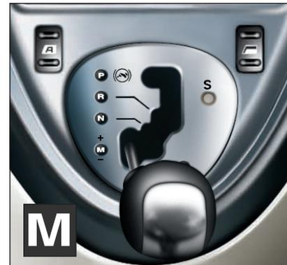
**Примечание.** Включенная передача указывается на приборной панели.
