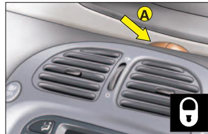
**Примечание.** При включенном зажигании световой индикатор, сигнализирующий о блокировке дверей и дверцы багажного отделения, загорается на дисплее комбинации приборов.
