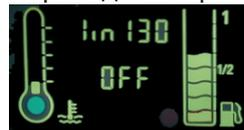
При выборе этой функции с помощью переключателя **1** последняя запрограммированная скорость отобразится на дисплее.
