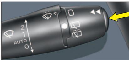
**Для обнуления бортового компьютера**, нажмите и удерживайте клавишу обнуления функций более трех секунд.
