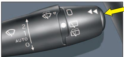
Краткими нажатиями на торцевую часть подрулевого рычага управления стеклоочистителями, можно вывести на дисплей и выбрать различные типы информации.
