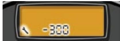
Через несколько секунд после включения зажигания счетчик пройденного расстояния начинает работать в обычном режиме, изображение гаечного ключа технического обслуживания продолжает гореть.
