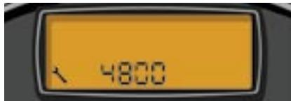
Через несколько секунд высвечивается индикатор уровня масла, затем счетчик пройденного расстояния начинает работать в обычном режиме. На дисплее появляются значения счетчика общего пройденного расстояния и расстояния, пройденного за день.
