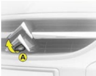
Переместите рычаг А, по центру капота, и поднимите капот.
