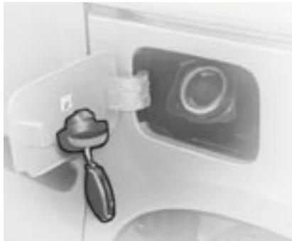
Для открывания лючка заправочной горловины топливного бака потяните за прорезь. На лючке имеется этикетка (см. "Качество топлива").
