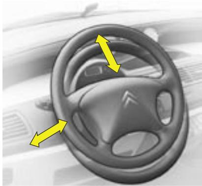
Регулировка положения рулевого колеса осуществляется по высоте и глубине.
