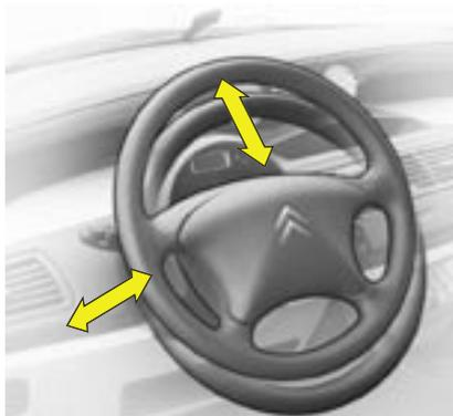
Регулировка положения рулевого колеса осуществляется по высоте и глубине. **НА СТОЯНКЕ** сначала отрегулируйте положение сиденья, затем рулевого колеса. см. Место водителя
