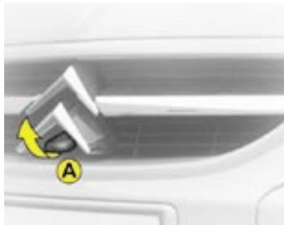
Переместите рычаг **A**, по центру капота, и поднимите капот.
