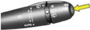
Краткими нажатиями на торцевую часть подрулевого рычага управления стеклоочистителями, можно вывести на дисплей и выбрать различные типы информации.
