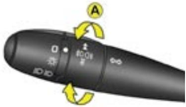
**Автомобиль, оборудованный передними противотуманными фарами и задними противотуманными фонарями (Кольцо А)**
