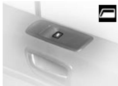
Управление электрическим стеклоподъемником передней двери со стороны пассажира осуществляется с помощью переключателя, установленного на этой двери.
