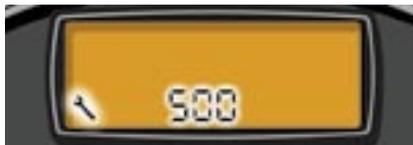
Через несколько секунд высвечивается индикатор уровня масла, затем счетчик пройденного расстояния начинает работать в обычном режиме, изображение гаечного ключа продолжает гореть.
