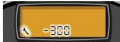
Через несколько секунд после включения зажигания счетчик пройденного расстояния начинает работать в обычном режиме, изображение гаечного ключа технического обслуживания должно гореть.
