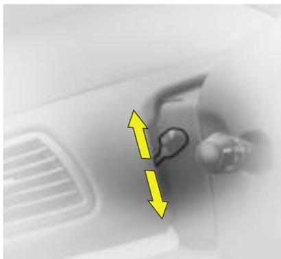
Разблокируйте рулевое колесо, переместив рычаг вниз. Отрегулируйте положение рулевого колеса и заблокируйте его, полностью вытянув рычаг вверх.
