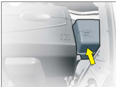
Предохранители в моторном отсеке
