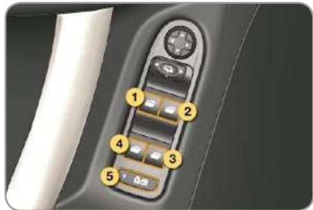
1. Выключатель стеклоподъемника двери водителя.
