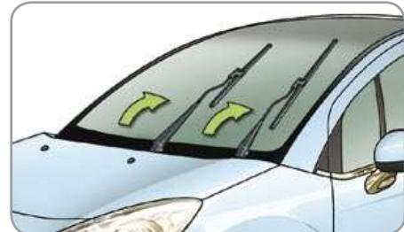
Это позволит поднять щетки при парковке автомобиля на морозе, очистить их или заменить, не повредив капот.
