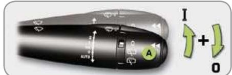
Функция отключается водителем, как только он переведет выключатель **A** вверх, а затем установит его на "0".
