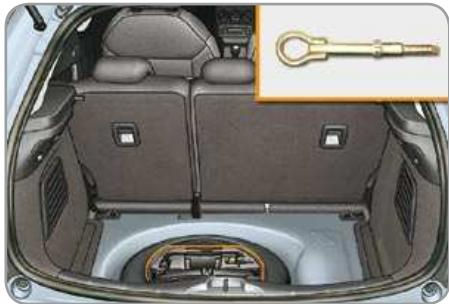
Буксировочное кольцо расположено под полом в багажном отсеке.
