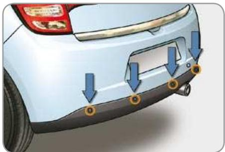
Датчики срабатывают при приближении к какому-либо препятствию (напр., к человеку, автомобилю, дереву, изгороди, ...), расположенному за автомобилем, кроме препятствий, расположенных под бампером.
