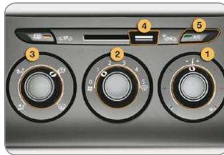
Передняя панель с электрическими регулировками
