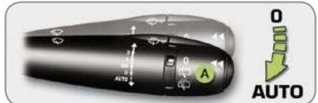
Функция автоматического включения стеклоочистителя активируется водителем, как только он переведет выключатель **A** в положение "AUTO".
