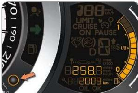
Общий пробег и расстояние, пройденное за поездку, отображаются на дисплее в течение 30 секунд при выключении зажигания, при открывании двери водителя, а также при за-пирании и отпирании автомобиля.
