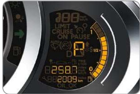
При перемещении селектора выбранный режим индицируется на дисплее приборной панели.
