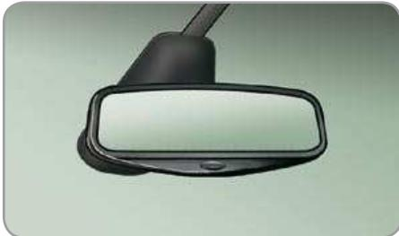
В автомобиле имеется датчик, определяющий уровень освещенности в задней части автомобиля, благодаря которому в нутрисалонное зеркало заднего вида обеспечивает автоматический плавный переход от дневного к ночному режиму работы.
