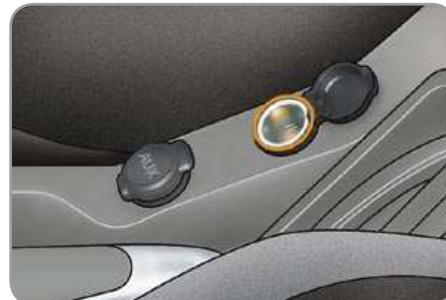
☞ Чтобы подключить к прикуривателю электрический прибор, работающий от напряжения 12 вольт (мощностью не более 120 Вт), откройте заглушку прикуривателя и вставьте в него соответствующий штеккер прибора.
