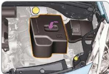
Аккумуляторная батарея расположена под капотом.
