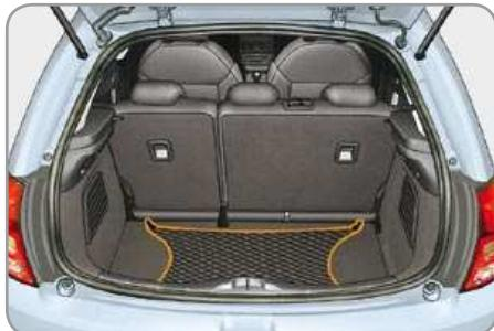
Прицепив сетку к кольцам, Вы можете закрепить свой багаж в передней части багажного отсека.
