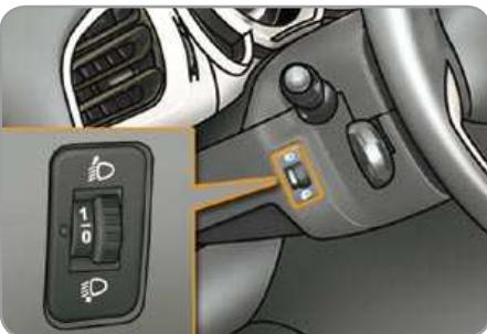
Чтобы не ослеплять других участников дорожного движения, необходимо отрегулировать угол наклона световых пучков фар в зависимости от загрузки автомобиля.
