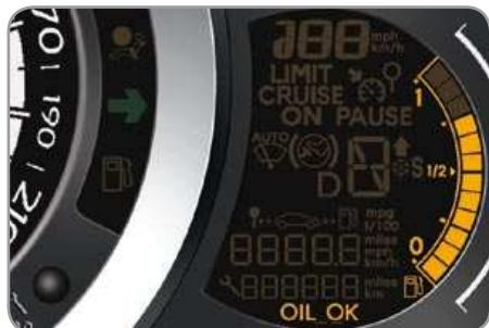
Индикатор показывает в течение нескольких секунд уровень масла в системе смазки двигателя при включении зажигания, сразу после информации о предстоящем плановом техническом обслуживании.
