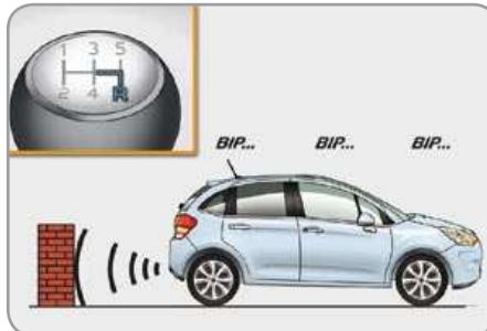
Система начинает работать сразу же после включения передачи заднего хода, при этом будет звучать зуммер.
