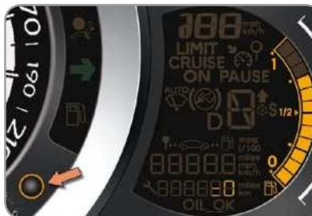
После прохождения очередного планового технического обслуживания счетчик указателя следует вновь установить на ноль.
