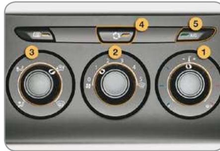
Системы отопления, вентиляции и кондиционирования воздуха работают только при запущенном двигателе.
