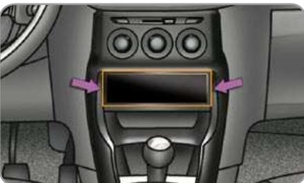
☞ При помощи отвертки снимите ящики для мелочей с обоих сторон.
