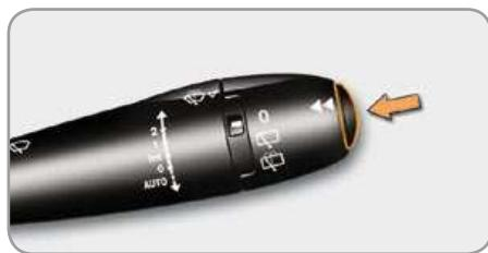
☞ Нажмите на кнопку, расположенную на торце **выключателя стеклоочистителя**, чтобы последовательно вывести на дисплей компьютера различные закладки.
