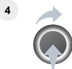
Выберите функцию Navi volume ("Громкость навигатора") и вращением ручки отрегулируйте уровень громкости речевых информаторов (сообщающих о дорожном движении, о сбоях в работе систем и т.д.).
