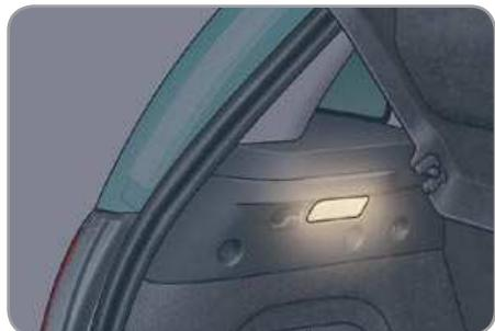
Он загорается автоматически при открывании и гаснет также автоматически при закрывании дверцы задка.
