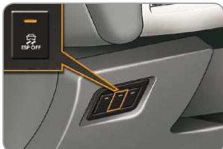
☞ Нажмите на кнопку "**ESP OFF**", расположенную слева под рулевым колесом.
