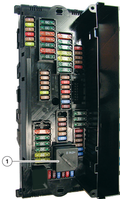
12 - Вид спереди переднего держателя предохранителей на F01/F02
