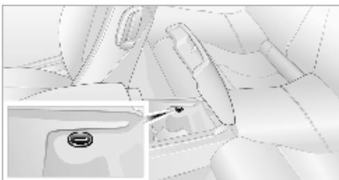
Поверните ключ в замке по часовой стрелке и выньте его. Теперь крышка багажника и ящик в передней центральной консоли заперты и не зависят от центрального замка.
