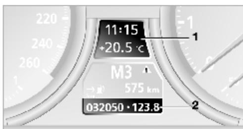
При выключенном зажигании Вы можете на короткое время вывести показания часов, температуры наружного воздуха и общего пробега, нажав левую нижнюю кнопку в комбинации приборов.
