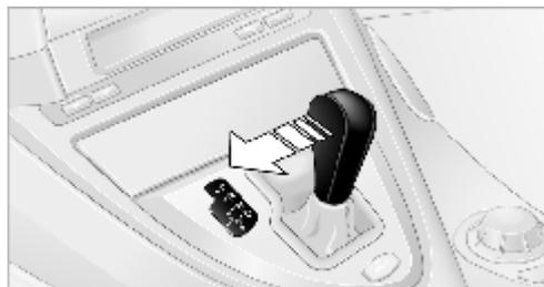
При переводе рычага управления из положения D в положение M/S включается спортивная программа, о чем сообщает появление букв DS на индикаторе включенной передачи. Это положение рекомендуется тем, кто предпочитает энергичную манеру езды.
