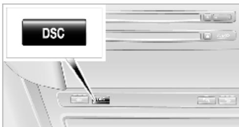
Выключение DSC автоматически влечет за собой отключение системы DTC. В этом случае стабилизирующее и усиливающее тягу воздействие на двигатель и тормоза отсутствует.
