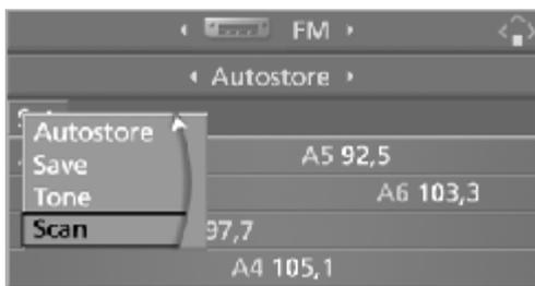
3. Выберите „Scan“ (Сканирование) и нажмите на контроллер. Запускается сканирование.
