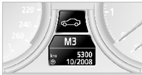
Если приближается срок очередного профилактического обслуживания или технического осмотра, то после поворота ключа зажигания в положение 2 в комбинации приборов высвечивается дата очередного обслуживания и остаточный пробег или дата технического осмотра.
