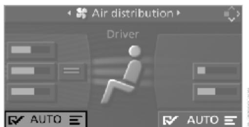
При включенном автоматическом распределении потоков воздуха высвечивается
