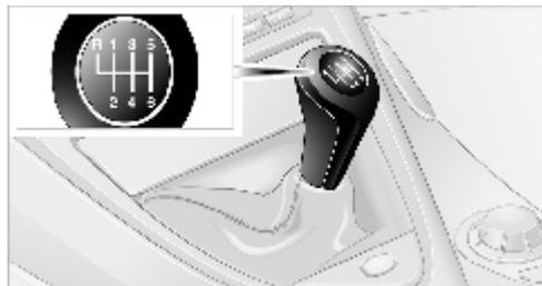
⚠ При переключении на V/VI передачи обязательной отжимайте рычаг переключения вправо, чтобы случайно не включить III или IV передачи. Остановившись на подъеме, не удерживайте автомобиль буксующим сцеплением. Используйте для этой цели стояночный тормоз. Пробуксовка сцепления ведет к его интенсивному износу. ◀
