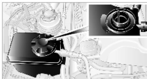
Уровень охлаждающей жидкости проверяют при холодном – около 20 °С – двигателе:
