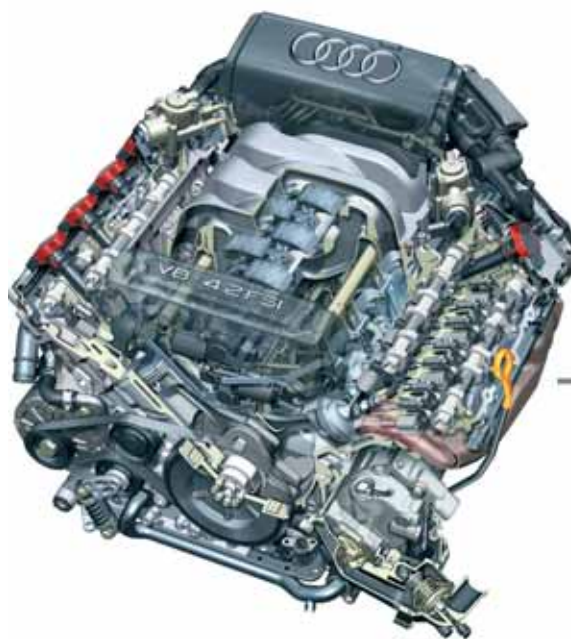
4,2 л V8 с непосредственным впрыском FSI
