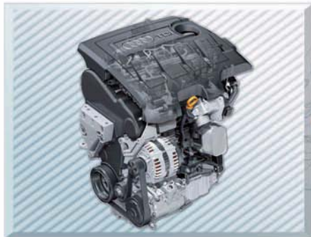
Двигатель 1,6 л TDI (77 кВт)
