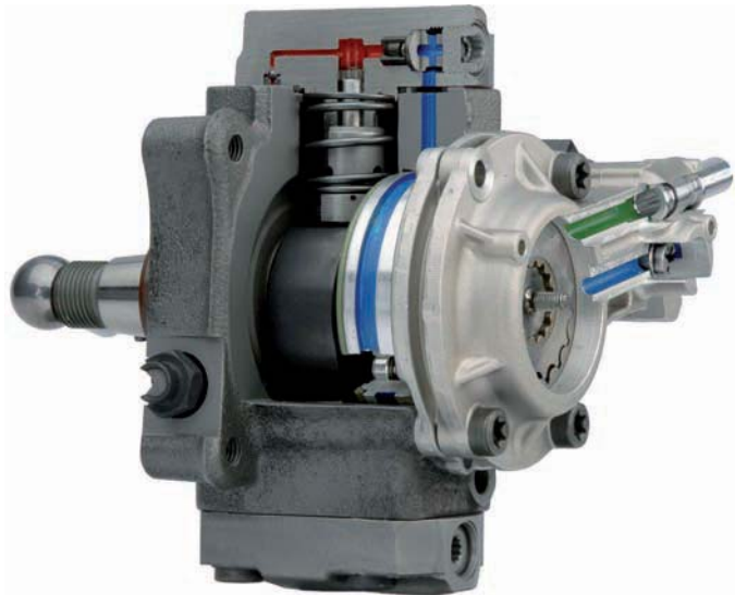
ТНВД со встроенным подкачивающим насосом (у двигателя 77 кВт) и клапаном дозирования топлива
