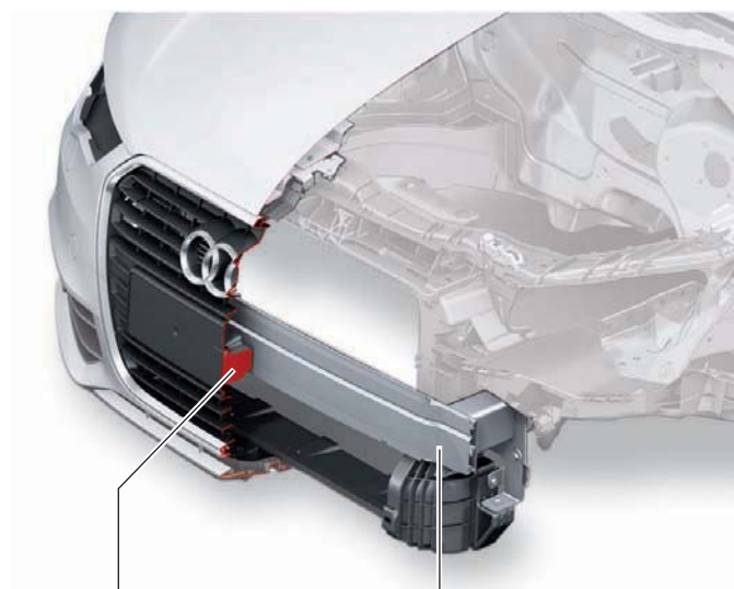
вспененный элемент для защиты пешеходов.
