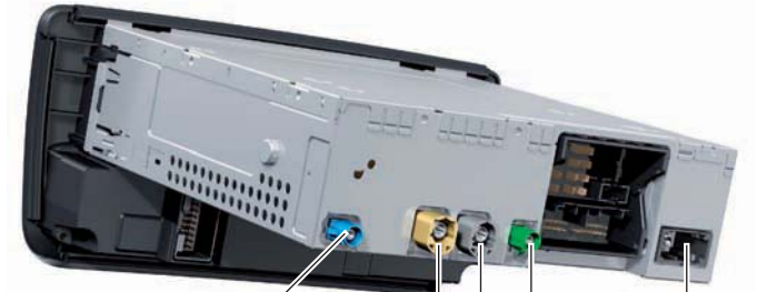
Тыльная сторона блока управления J794 в MMI 477_072
