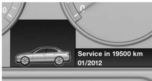
Система получает данные о безопасности при движении и эксплуатационной надежности автомобиля и учитывает такие аспекты, как, например, своевременная проверка автомобиля. Ее целью является снижение общих затрат владельца на содержание автомобиля.
