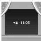
Расчетное время прибытия отображается, если перед началом движения в систему навигации\* была введена цель.
