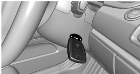
При соответствующем сообщении системы автоматической диагностики пульт дистанционного управления, как на изображении, держать у маркировки на рулевой колонке и нажимать в течение 10 секунд кнопку Start/Stop при нажатом тормозе.
