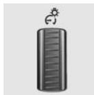
Для регулировки яркости подсветки должны быть включены стояночные огни или ближний свет.
