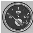
▶ Холодный двигатель: стрелка находится на низком значении температуры. Ехать при умеренном числе оборотов и с умеренной скоростью.
