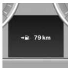
При снижении уровня топлива до резервного объема:
