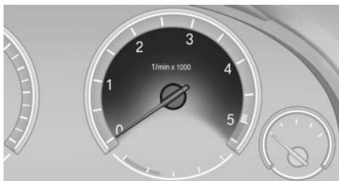
Ни в коем случае не доводите обороты двигателя до значений красного предупреждающего сектора. В целях защиты двигателя в этом диапазоне прекращается подача топлива.
