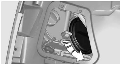
Отвинтите и снимите крышку, замените лампу.
