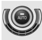
Чтобы установить нужную температуру, поверните колесико.
