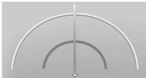
Расстояние прицепа до тягово-сцепного устройства можно определить с помощью двух статических полуокружностей.
