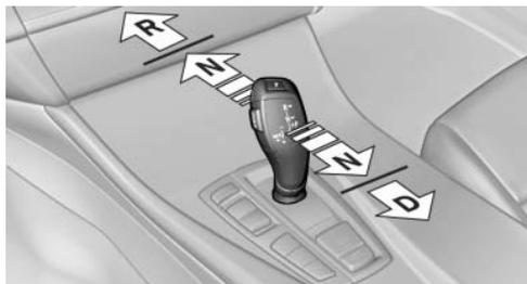
Переместить рычаг селектора в желаемом направлении, при необходимости с переходом за точку срабатывания.
