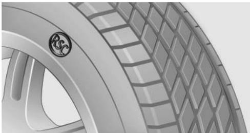
Маркировка шин, допускающих движение в аварийном режиме, на боковой стенке шины. Колеса состоят из самонесущей шины и специального диска.
