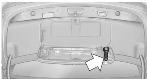
Всегда возите с собой привинчиваемую буксирную проушину. Ее можно привинтить к BMW спереди или сзади. Она находится на внутренней стороне крышки багажника в контейнере.
