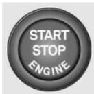
При нажатии на кнопку пуска/выключения двигателя зажигание включается или выключается, а также запускается двигатель.
