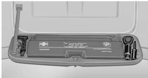
Комплект инструментов находится в откидной крышке в крышке багажника.
