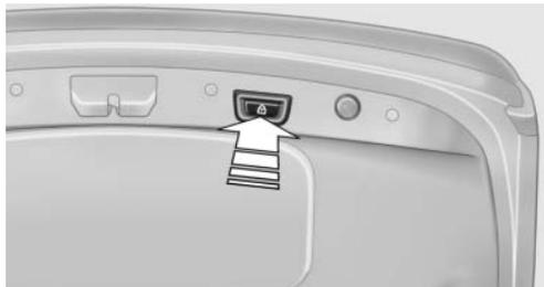
Нажать клавишу на внутренней стороне крышки багажника.
