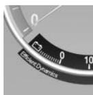
Энергия движения автомобиля в режиме принудительного холостого хода преобразуется в электроэнергию. Частично заряжается батарея автомобиля,
