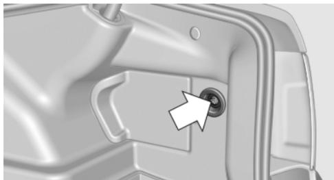
Кнопка для выдвигания и задвигания шарового шарнира находится в багажном отделении.
