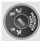
Вставьте ключ и при необходимости еще раз нажмите на него. Удерживайте его нажатым и поверните до упора в положение OFF. На упоре выньте его.
