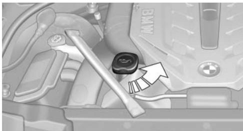
При индикации в комбинации приборов на протяжении следующих 200 км залить 1 литр масла.
