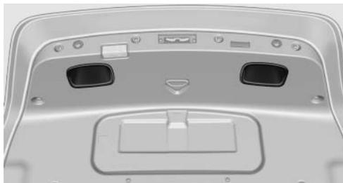
В углублениях обшивки внутренней стороны крышки багажника находятся ручки, облегчающие ее опускание.
