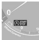
Индикатор сигнализирует, что система автоматического запуска/останова двигателя готова к автоматическому пуску двигателя.
