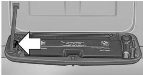
Фиксатор колесного болта находится в бортовом инструменте или в месте для хранения рядом с ним.
